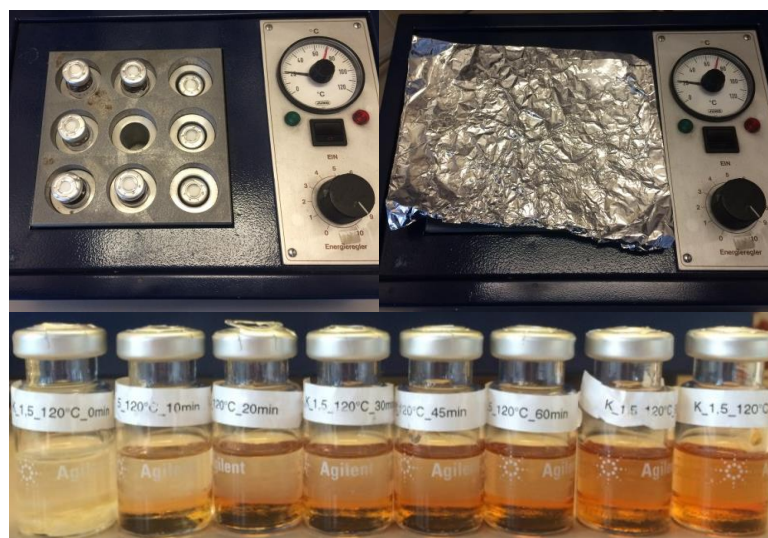
Abbildung 101: Heizblock zur Synthese der Proben für die kinetische Analyse der Harzbildungsreaktion (oben) und die synthetisierten Proben bei 120 °C
