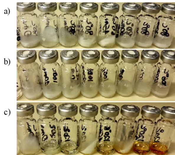
Abbildung 48: Synthetisierte Harze aus Resorcin und HMMM im Molverhältnis 1:1,5 bei a) 80 °C, b) 100 °C und c) 120 °C
