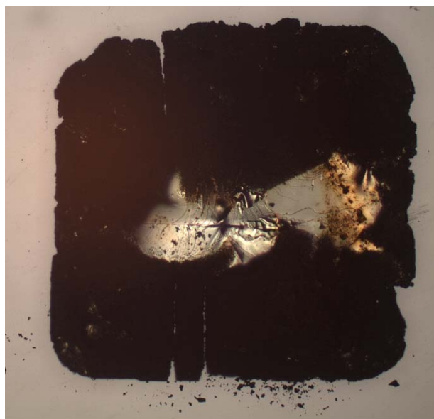
Abbildung 6.28: TiTe 2 -Einkristall, der acht Tage lang bei Raumtemperatur der BuLi-Lösung mit einer Konzentration von 1,6 \text{ mol}\cdot\text{L}^{-1} ausgesetzt war. Die Oberfläche ist in der Mitte intakt, die Kanten sind korrodiert, sie zerfallen. Die Kantenlänge des Vierecks beträgt 2 mm (Probe 1,6TITE8d).
