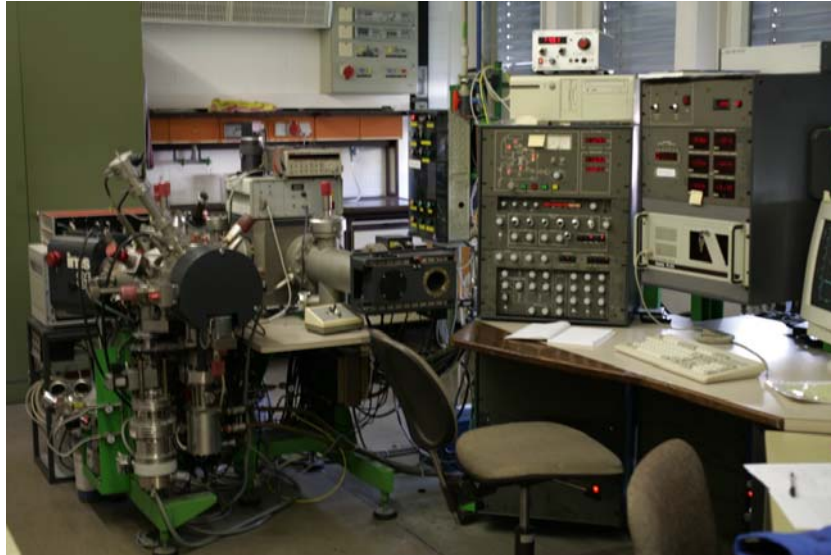
Abbildung 5.11: SIMS CAMECA IMS 3f von der Arbeitsgruppe SCHMIDT in Clausthal-Zellerfeld. Rechts ist die Probenkammer zu sehen, mittig das Massenspektrometer. Links werden die Geräteeinstellungen getätigt und die Messungen auf Bildschirmen verfolgt.
