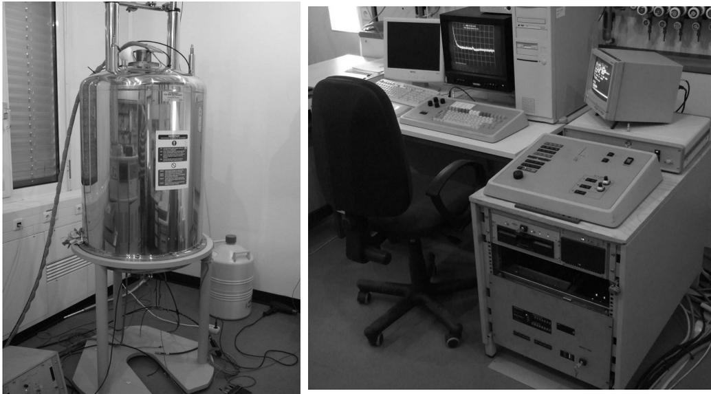
**Abbildung (B.4)** *Links:* Oxford Teslatron Kryomagnet (9,4 Tesla).
