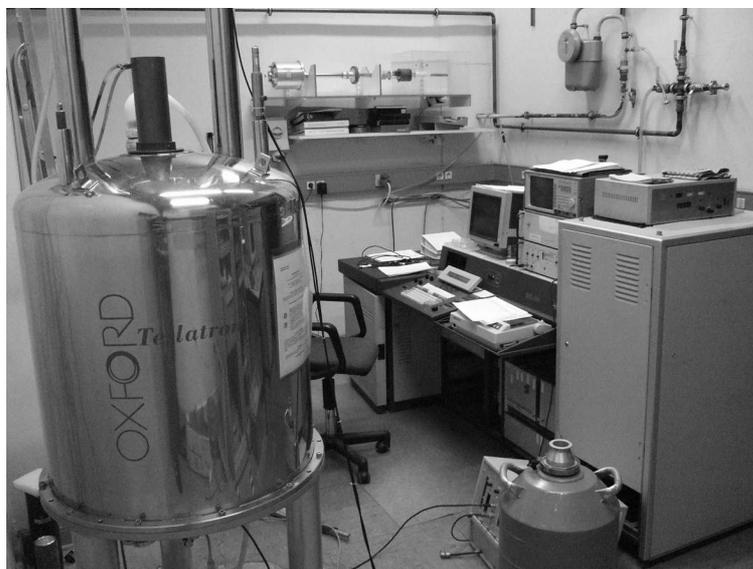
**Abbildung (B.3)** Bruker MSL 100 Festkörper-NMR-Spektrometer und feldvariabler Oxford Teslatron Kryomagnet. Zur Signalverstärkung wird statt des mitgelieferten Verstärkers ein Kalmus Hochleistungsverstärker mit 400 W Spitzenleistung verwendet. Die Temperatursteuerung befindet sich in einem separaten Rack (hier nicht gezeigt).
