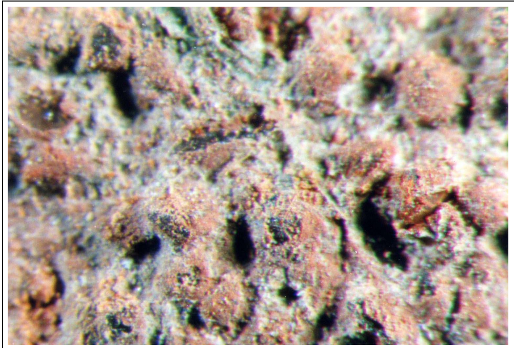
Abb. 13: S1 oberhalb der Horizontalsperre: Hier zeigt S1 ein leichtes Abwittern der Oberfläche. (50-fache Vergrößerung)
