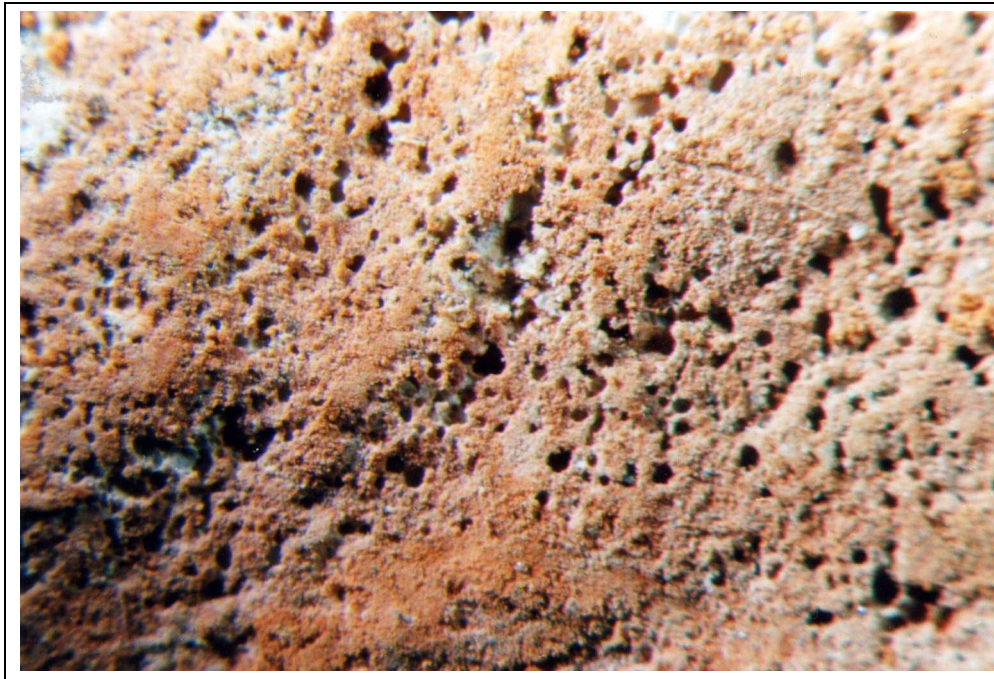
Abb. 19: S10 oberhalb der Horizontalsperre: S10 fällt durch die stark poröse obere Schicht auf, durch die sich die weiße Zwischenschicht erkennen läßt (20-fache Vergrößerung).
