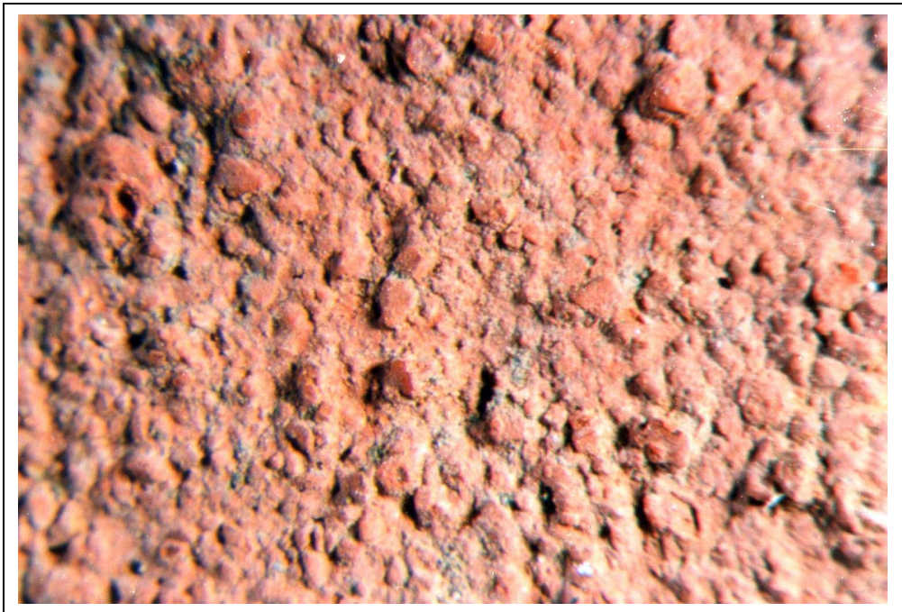
Abb. 22: S15 unterhalb der Horizontalsperre: S15 zeigt auch hier ein intaktes Erscheinungsbild (20-fache Vergrößerung).
