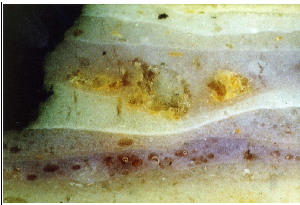
Abb. 35: Ausschnitt eines Anschliffs der Schichtenabfolge Südwand ev. ref. Kirche in Campen, Südwand unter dem Westjoch
