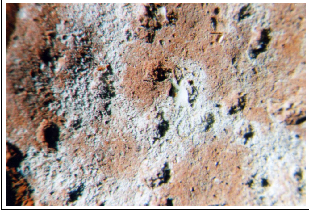
Abb. 21: S14 unterhalb der Horizontalsperre: Hier sind die Glimmer bereits herausgewittert (20-fache Vergrößerung).
