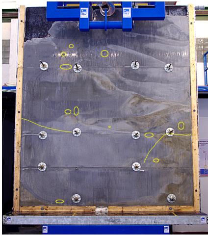
Abbildung 8.31: Ausgeschaltete Bauteil, Risse und größere Fehlstellen sind gelb markiert
