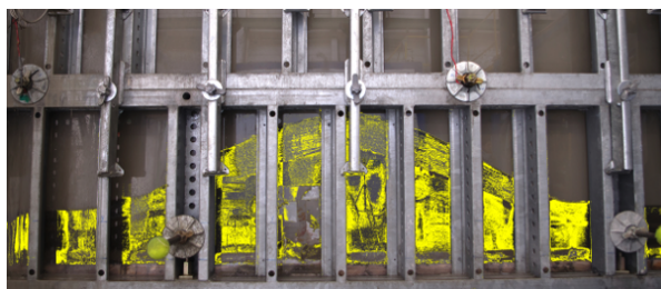
Abbildung 8.47: Ausbildung eines „Schüttkegels“ zu Beginn des Verfüllversuchs, ausgewaschenes Grout-Material ist im Bild gelb eingefärbt
