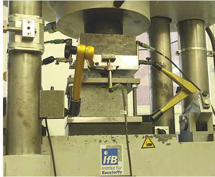
Abbildung 9.2: Messaufbau für die Stempelversuche
