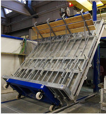
(a) Kippen der Versuchsschalung
