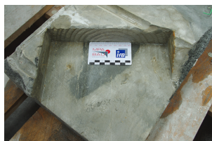
(a) Ablagerungen im Bereich der Schikane
