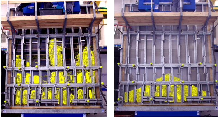
(a) „Wolke“ aus ausgewaschenen Fein- (b) „Schüttkegel“ aus ausgewaschenen Feinanteilen nach dem Eintritt ins Wasser nem Grout-Material
