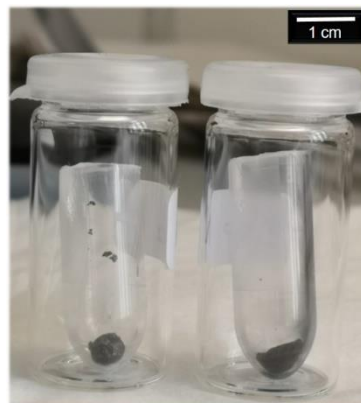
Abbildung 62: Fotos von freistehenden Cryohydrogelen, die nach dem Auftauen überkritisch getrocknet wurden. Links: mit flüssigem Stickstoff bei -196\text{ °C} eingefroren. Rechts: mit Isopentan bei -160\text{ °C} eingefroren.
