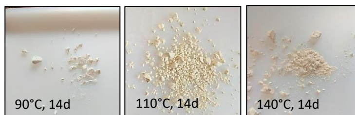
Abbildung 41: Photographische Abbildungen des in Aceton getrockneten Glucans, welches jeweils über 14 Tage bei unterschiedlichen Temperaturen gelagert wurde.
