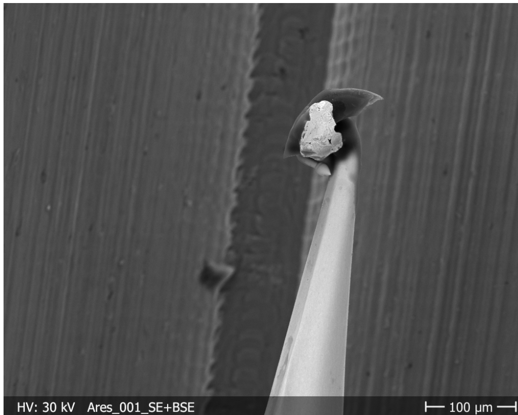
Abbildung 5.4.: BSE-Aufnahme der Probe K001 an einer Wolframnadel
