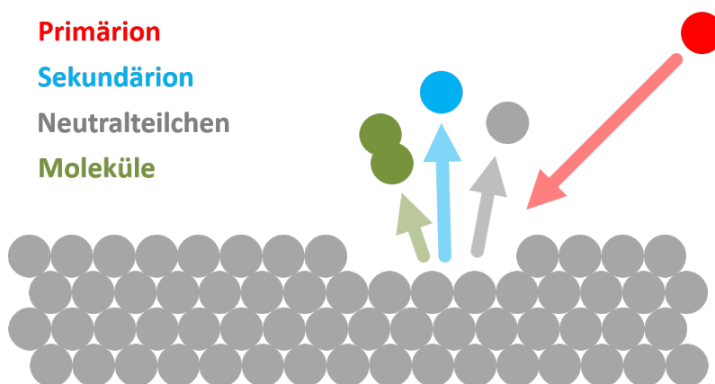
Abbildung 2.3.: Schematische Darstellung des Sputterprozesses
