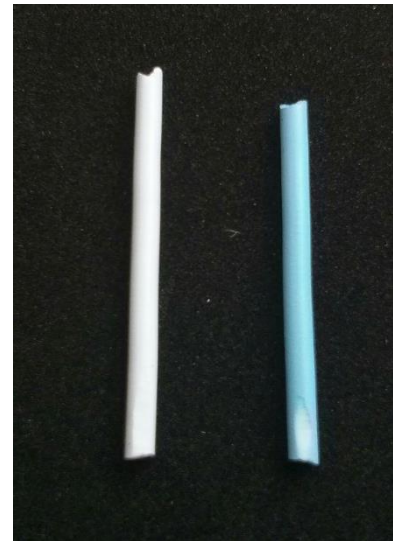
Abbildung 14: Coomassie gefärbte und gespülte Kapillaren mit adsorptiv (links) und kovalent (rechts) gebundenen Proteasen
