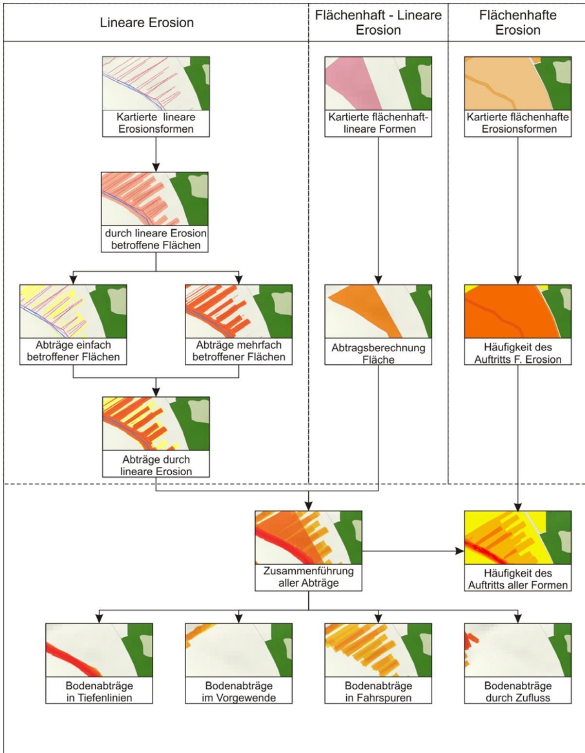
Abb. 14: Schema der GIS-gestützten kleinräumlich differenzierten Auswertung der Bodenerosion
