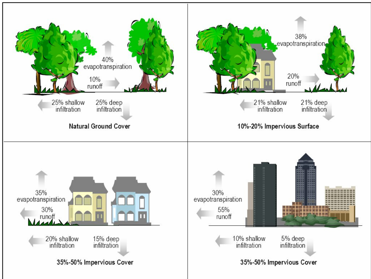
Abbildung 6: Veränderung des Wasserhaushaltes durch Urbanisierung [US-EPA 2005]
