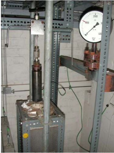
Abbildung 20: Links: Reaktionsautoklav angeschlossen an die Hochdruckapparatur; rechts: Vorratsautoklav mit Verbindung zur Gasflasche.
