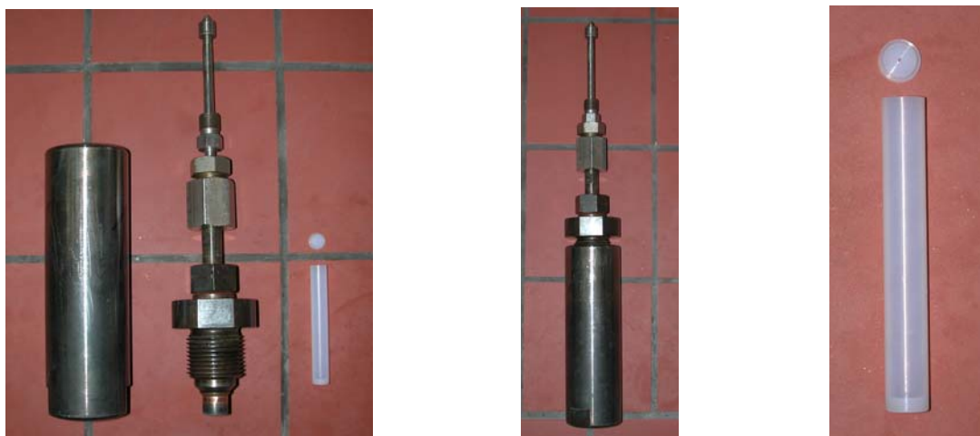
Abbildung 19: Hochdruckautoklav; links: geöffnet mit Reaktionsröhrchen; Mitte: geschlossen; rechts: Reaktionsröhrchen. Das Reaktionsröhrchen weist eine Länge von 9 cm auf.
