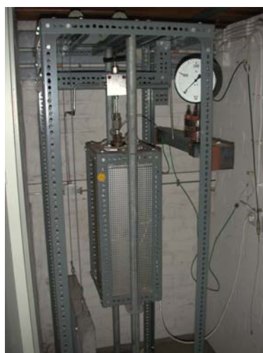
Abbildung 22: Reaktionsautoklav mit hochgeschobenem Ofen.
