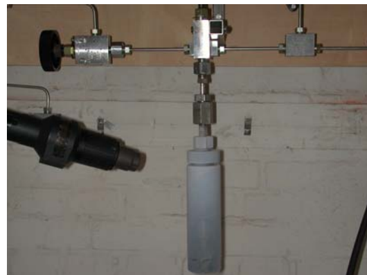
Abbildung 21: Einkühlen (links) und Erwärmen (rechts) des Vorratsautoklaven.
