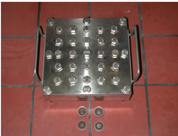
Abbildung 24: links: Autoklavenblock geschlossen mit zwei Einsatzgefäßen aus Teflon (beide geöffnet), rechts: Autoklavenblock geöffnet. Die Maße des Autoklavenblocks betragen 21 x 21 cm, die Einsatzgefäße besitzen eine Höhe von 2.5 cm und einen Innendurchmesser von 1.5 cm.
