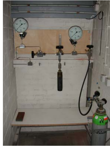
Abbildung 20: Links: Reaktionsautoklav angeschlossen an die Hochdruckapparatur; rechts: Vorratsautoklav mit Verbindung zur Gasflasche.
