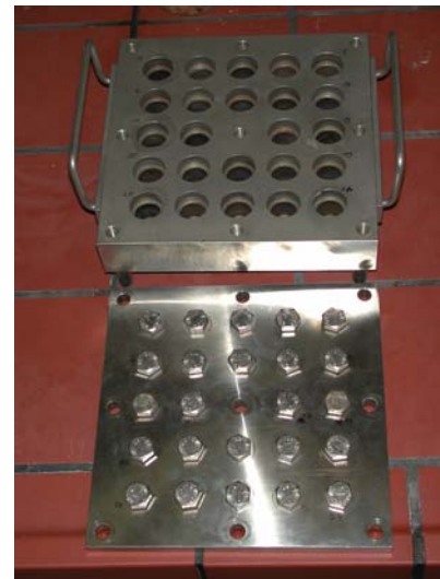
Abbildung 24: links: Autoklavenblock geschlossen mit zwei Einsatzgefäßen aus Teflon (beide geöffnet), rechts: Autoklavenblock geöffnet. Die Maße des Autoklavenblocks betragen 21 x 21 cm, die Einsatzgefäße besitzen eine Höhe von 2.5 cm und einen Innendurchmesser von 1.5 cm.
