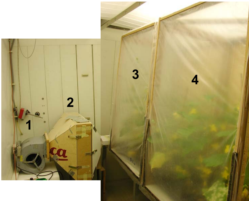
Abbildung 3.2 Versuchsanlage zur Durchführung der Mischinfektionsversuche. Im hinteren Teil der Klimakammer ist das Gebläse zusehen (1), an das der Schwebstofffilter (2) angeschlossen ist. Im Vordergrund stehen die beiden separaten Versuchsboxen (3 und 4).
