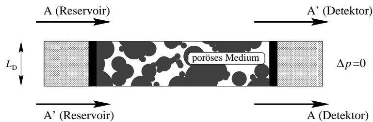
Abb. 1.8: Schematischer Aufbau des WICKE-KALLENBACH-Experiments zur Messung des effektiven Diffusionskoeffizienten unter stationären Bedingungen.
