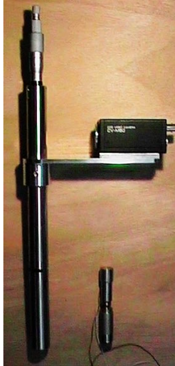
Abbildung 4.1: Machbarkeitsstudie eines In-situ Mikroskops. Rechts der ausgebaute Motor mit der Beleuchtungseinheit.
