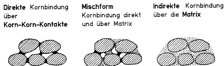
Abbildung 2.6: Vereinfachte Darstellung des mikrostrukturellen Aufbaus von Sandstein [4]
