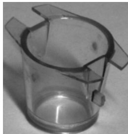
Abb. 1.8 Zellkultur-Insert (Transwell in 12-Well-Format, 1,09 cm 2 , Fa. Falcon) mit einer Wachstumsfläche aus mikroporöser Membran.
