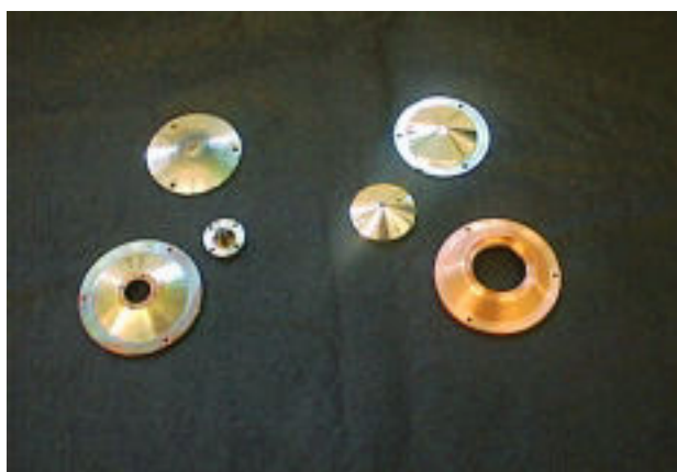
Abb. 8.14 Alte Mini-Conen (links) und neue \mu -Conen (rechts) für das PQ2. Von oben nach unten: Sampler, Skimmer und Skimmer-Mountingplate.
