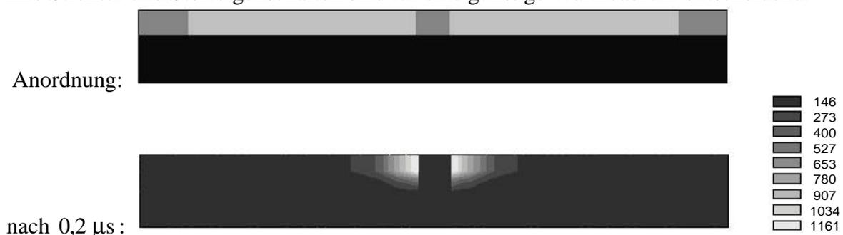
**Bild 6.1.2.2:** Temperaturverteilung in  $^{\circ}\text{C}$  innerhalb einer Graphitfremdschicht bei  $U = 230$  V
