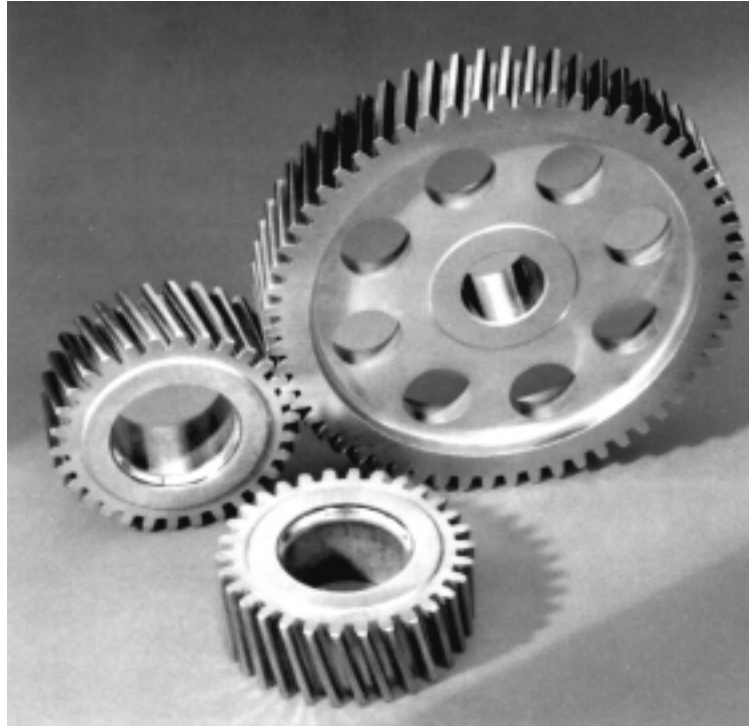
Abb. 2.10: Pulvergeschmiedete Zahnräder (Werkbild: Mannesmann DEMAG)
