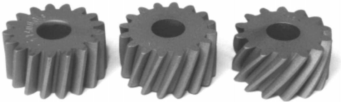
Abb. 6.30: Geschmiedete Zahnräder mit variiertem Schrägungswinkel
