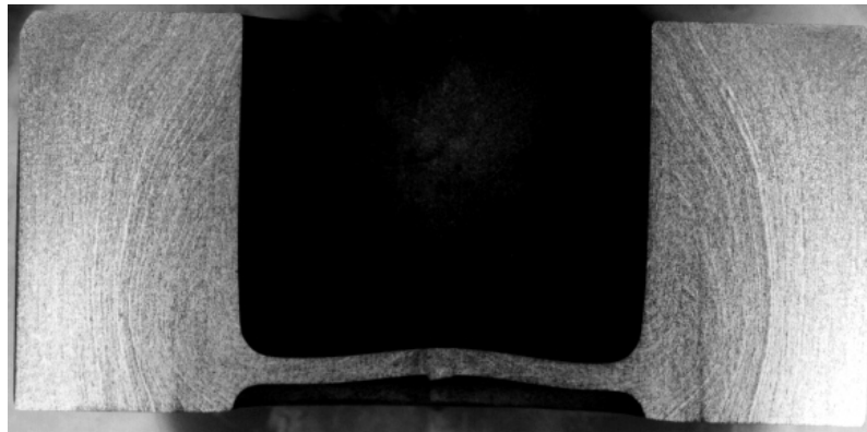
Abb. 7.5: Querschliff durch das geschmiedete Lkw-Planetenrad
