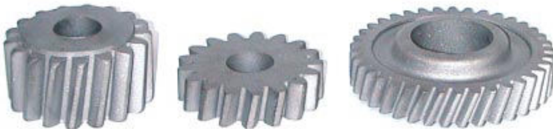
Abb. 6.10: Geschmiedete Zahnräder (Geometrie A, B, C)
