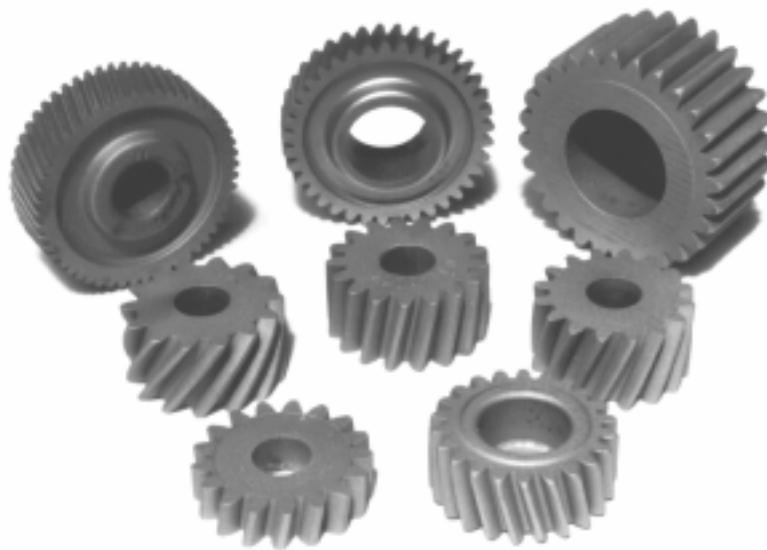
Abb. 9.1: Im Rahmen der vorliegenden Arbeit geschmiedete Zahnradgeometrien
