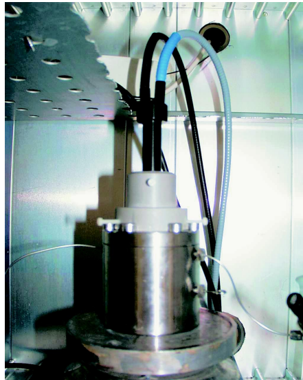
Abb. 13.6: Der Reaktor inkl. Lichtleiter und Fixieraufsatz [Knüttel; 1999]
