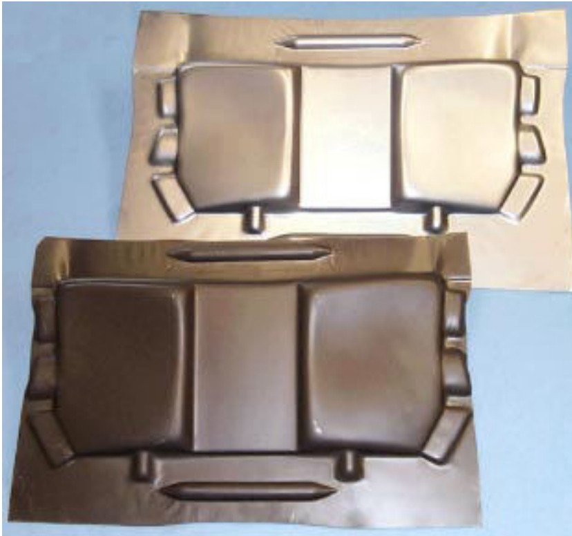
Bild 94 : Lackiertes Blech (KTL-Ersatzsystem Zincroplex Black) und Blechteil Nr. 10.000, gezogen mit Galvanotiefziehwerkzeug
