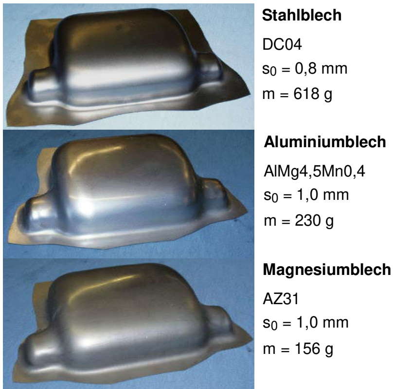
Bild 91: Teile, umgeformt mit temperaturbeständigem Tiefziehwerkzeug [Fran99]
