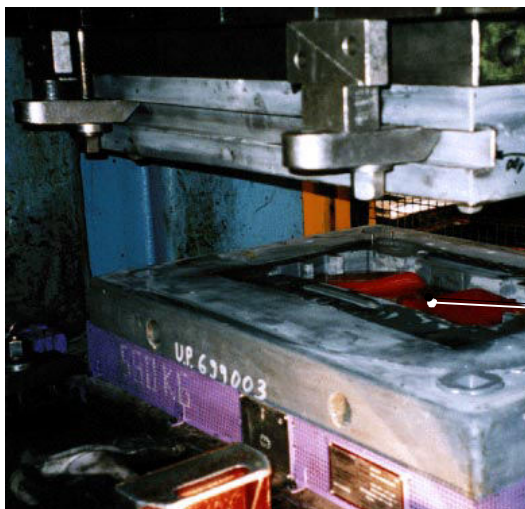
Bild 93: Praxiswerkzeug zur Fertigung eines Verstärkungsblechs als Doppelteil (Quelle: ebalta Kunststoff GmbH)
