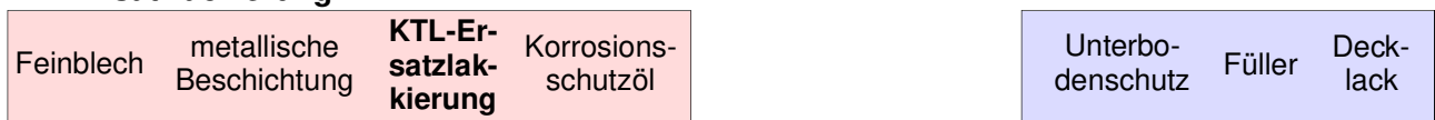
Bild 13: Verkürzung der Prozeßkette durch den Einsatz von beschichteten Feinblechen (nach: Salzgitter AG)
