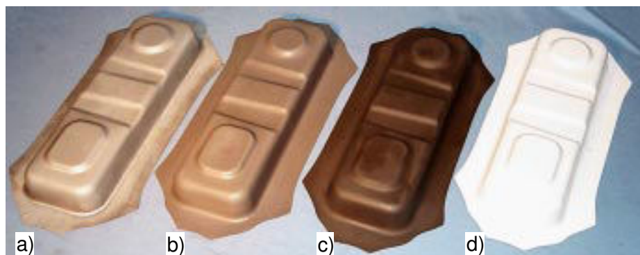
Bild 89: Tiefziehteile mit verschiedenen organischen Beschichtungen, gezogen mit Kunststoffmatrize
