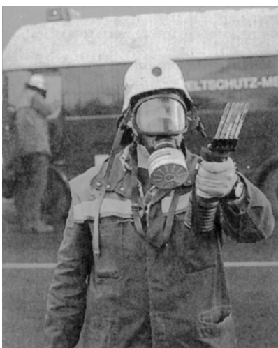
Abb. 25. Vor-Ort-Analyse von Brandgasen mit DRÄGER-Röhrchen-Set.
