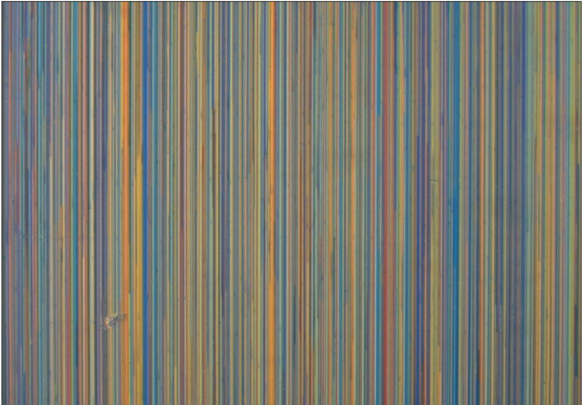
**Abbildung 5.1:** Mikroskopisches Bild einer superterrasierten Silizium Oberfläche. Der gezeigte Ausschnitt entspricht einem Bereich von  $1.5\text{mm} \times 1\text{mm}$  auf der Probe.
