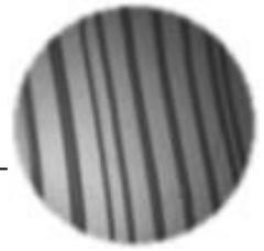
Oberfläche bleibt jedoch bestehen (d). Bei dem nachfolgenden Abkühlen entsteht der Domänenkontrast wieder — allerdings ordnen sich die Spiegeldomänen unerwarteterweise an den selben Stellen an, wie zuvor. Die Domänenwandstruktur der  $(5 \times 3.2)$  Rekonstruktion durchläuft während der Temperkurve zwar einen Ordnungs–Unordnungs Phasenübergang, “merkt” sich dabei jedoch die vorherige Anordnung der Spiegeldomänen.
