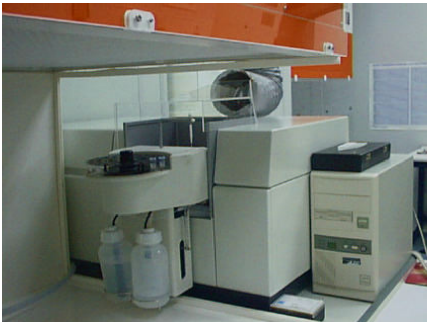
Abb. 5.3 Aufbau des AAS 5 EA unter einer clean-Bench zur Verringerung der Leerwerte und Streuungen.
