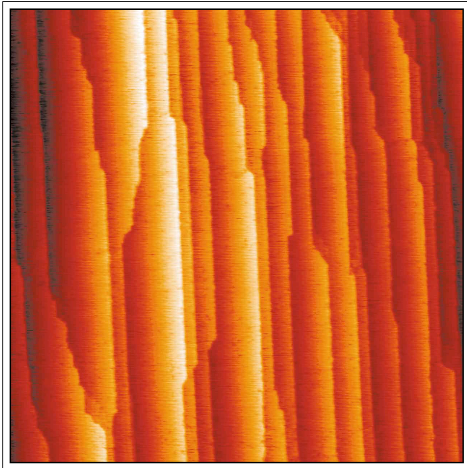
Abb. 3.8: Bei 1260 °C eingefrorene Struktur der Siliziumoberfläche ( 200 \times 200 \text{ nm}^2 )
