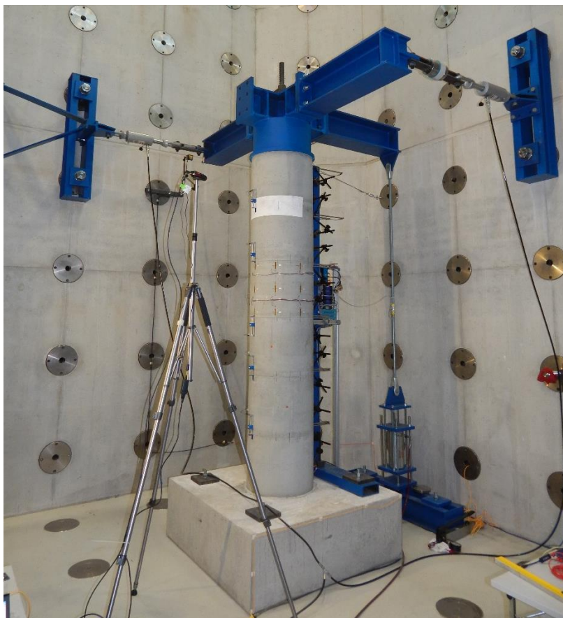
Abbildung 6-8: Großversuch zum Torsionstragverhalten von Kreisringsegmenten
