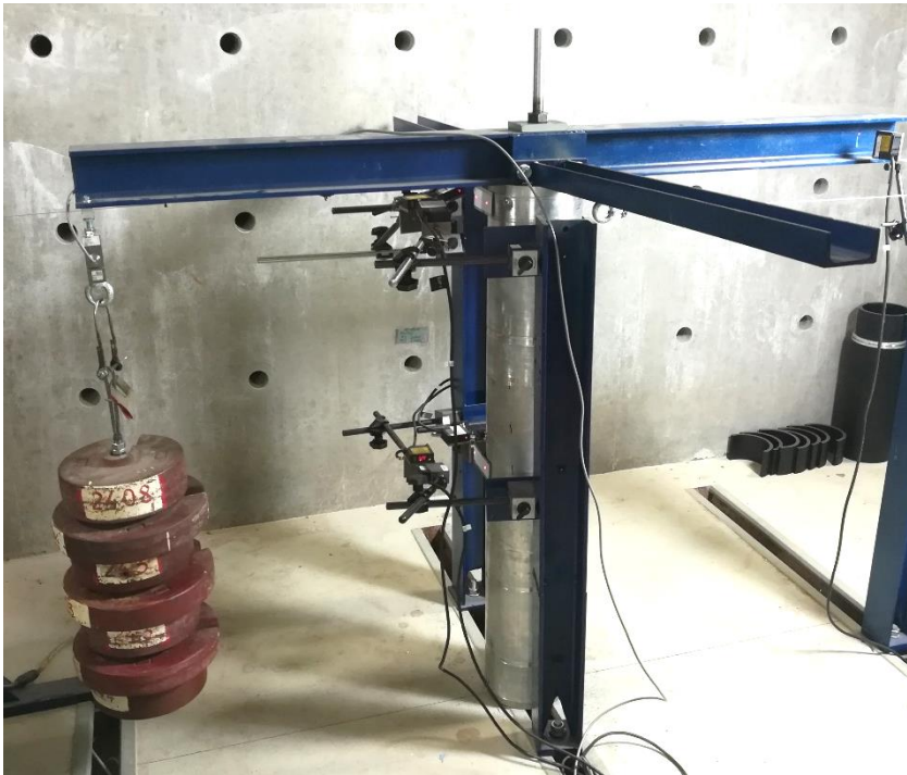
Abbildung 6-2: Versuchsstand der Aluminiumrohrversuche mit Belastung
