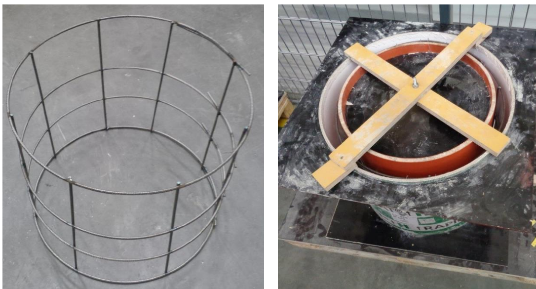
Abbildung 6-7: Bewehrungskorb und Schalung für die Segmentherstellung
