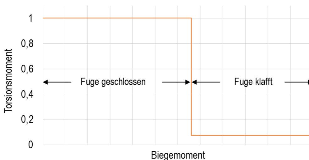
Abbildung 4-1: Ertragbares Torsionsmoment (normiert) unter ansteigendem Biegemoment
