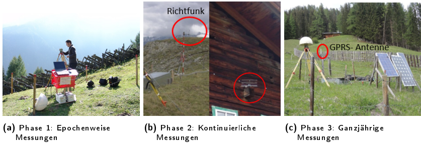
Abbildung 3: Fotos der Setups der unterschiedlichen Phasen: Epochenweise Messungen (links), kontinuierliche Messungen mit Richtfunk ins Tal (Mitte) und ganzjährige Messungen mit UMTS Übertragung ins Auswertezentrum (rechts)
