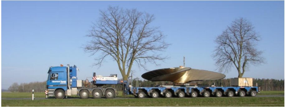
Abbildung 2: Schwerlasttransport eines Schiffspropellers als definierter Lastfall
