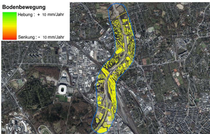
**Abbildung 1:** Beispiel einer PSInSAR-Auswertung entlang einer Baumaßnahme an der A7 in Hamburg (Ergebnis aus Datenschutzgründen farblich homogenisiert)
