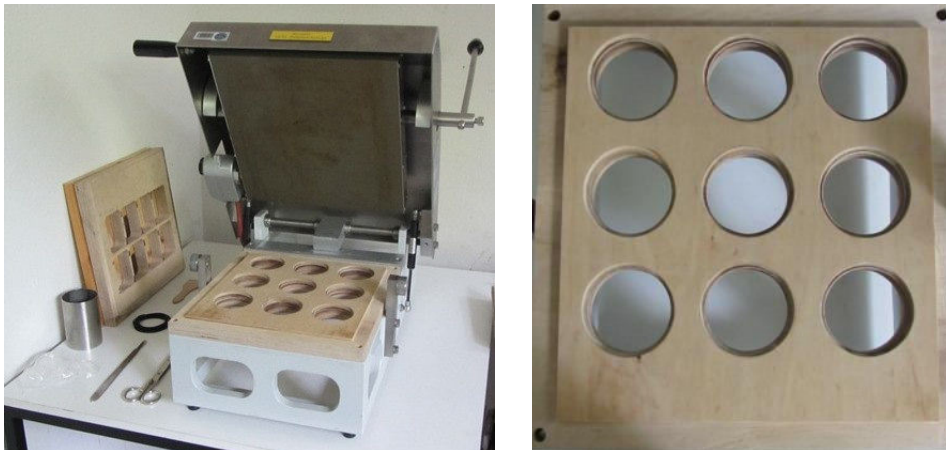
Abbildung 4.2: Zum Verschließen der Reaktoren verwendete Geräte. Links: Handsiegelgerät Silius Basic; Rechts: Konstruierter Siegelrahmen zur Aufnahme der Becher während des Siegelvorgangs
