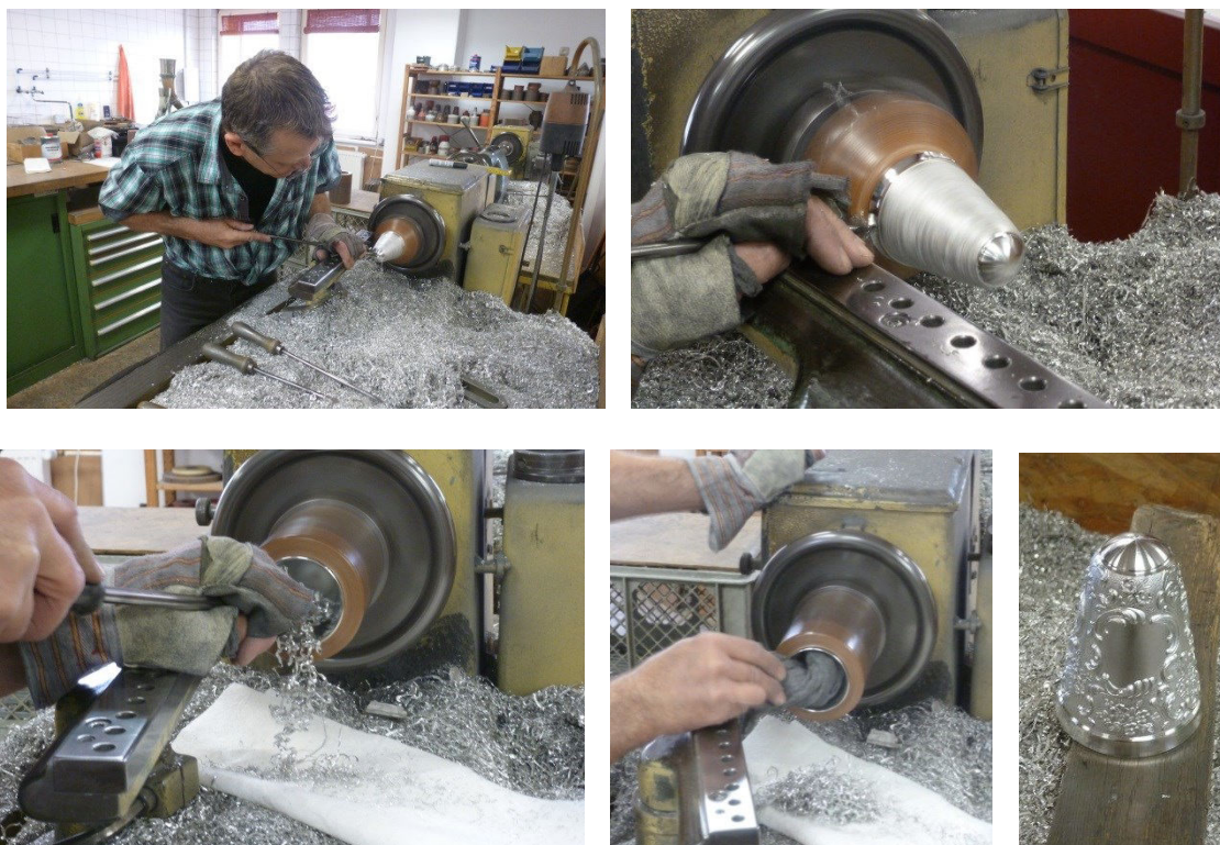
Abbildung 8-14 An einer Drehbank werden Außen- und Innenseite des Bechers für eine glatte und glänzende Oberfläche bearbeitet.
