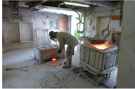
Abbildung 8-21 Links: In Zirkonsand gebettete Gussformen, Rechts: Tiegelentnahme aus dem Ofen.
