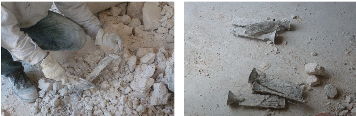
Abbildung 8-26 Herausnehmen der Gussstücke aus dem zur Stabilisierung verwendeten Metallgitter.
