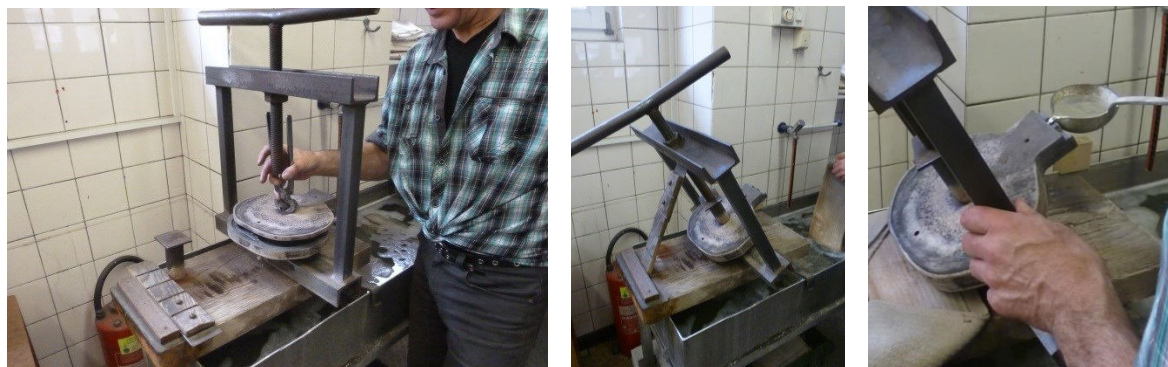
Abbildung 8-8 Zusammensetzen und Einspannen der Gussform in eine Presse über einem Wasserbecken. Das flüssige Zinn wird mit einem Gießlöffel schräg in den Gusskanal eingegossen.
