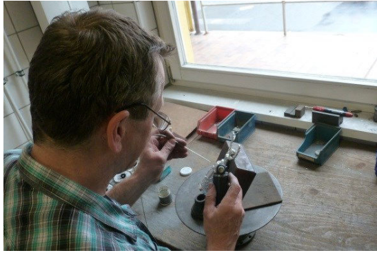
Abbildung 8-15 Anlöten der Figur an den Brautbecher.
