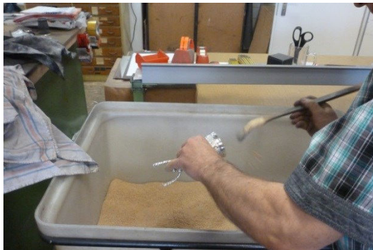
Abbildung 8-17 Trocknen des Brautbechers mit Sägemehl und Einsetzen des kleinen, schwenkbaren Bechers.
