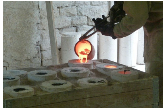
Abbildung 8-21 Links: In Zirkonsand gebettete Gussformen, Rechts: Tiegelentnahme aus dem Ofen.
