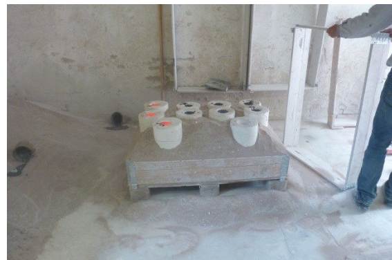
Abbildung 8-24 Fertig abgegossene Gussformen und Entnahme aus dem Zirkonsand.
