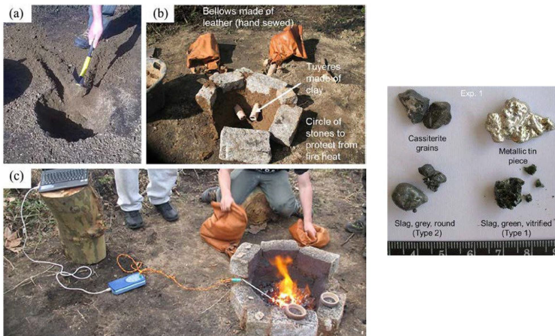
Abbildung 2-5 Experimente zum Reduzieren von Kassiterit mit Holzkohle nach historischem Vorbild. Links: (a) Graben der Ofengrube und der Rinnen für die Belüftungsrohre, (b) Finale Konstruktion mit Steinkreis zum Schutz vor Hitze, (c) Temperaturmessungen während der Reduktion, Rechts: Verwendete Kassiteritkörner und Reduktionsprodukte (FIGUEIREDO et al. 2016)
