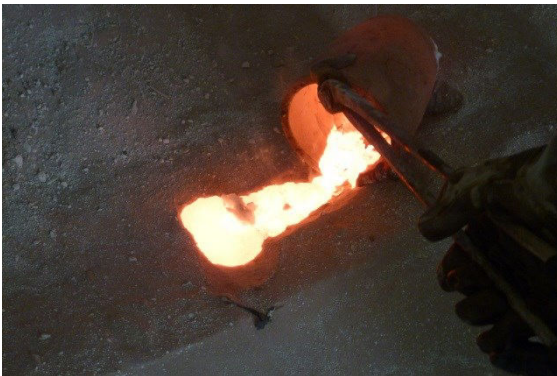
Abbildung 8-23 Ausgießen von Metallresten im Tiegel in Zirkonsand.
