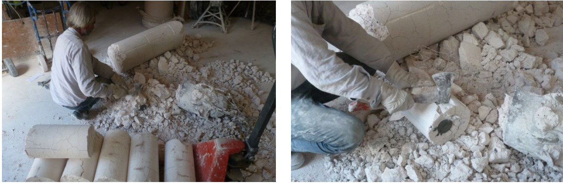
Abbildung 8-25 Herausschlagen der Gussstücke aus den Gussformen
