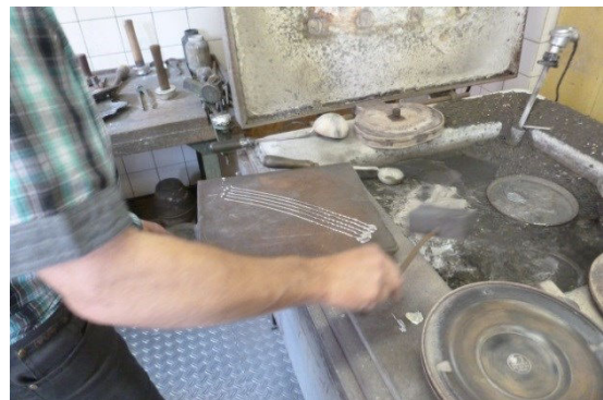
Abbildung 8-18 Links: Tropfprobe vom Gießkanal eines Bratwurstherzels, Rechts: Herstellung von Zinnloten aus der Zinnschmelze.
