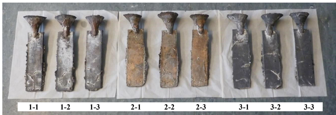
Abbildung 8-28 Mit Wasser gereinigte Gussstücke mit Eingusstrichtern. Von links nach rechts GBz10 (1-1 bis 1-3), Rg5 (2-1 bis 2-3), GBz12 (3-1 bis 3-3), vergl. Tabelle 8-2).
