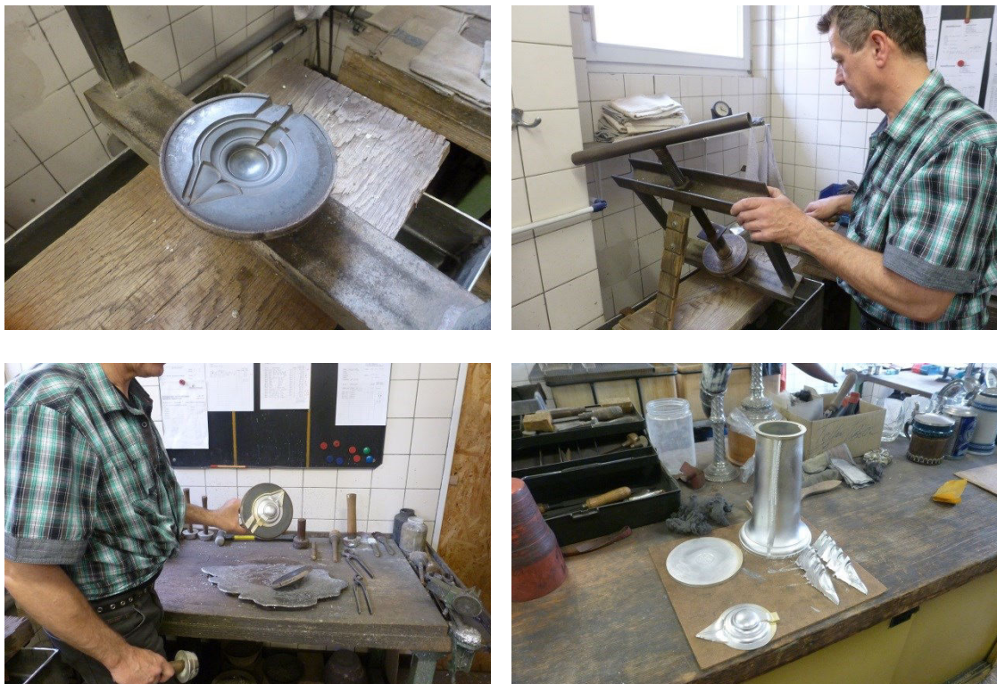
Abbildung 8-11 Herstellung von Deckeln für Zinnkannen im Heißgussverfahren (analog zu den Abbildungen 8-7 bis 8-10).
