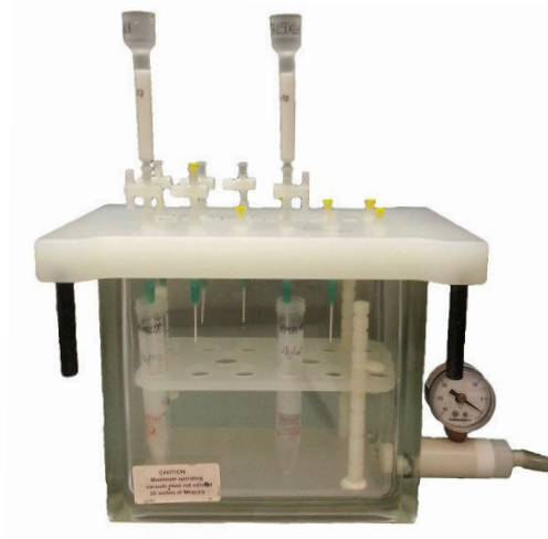
Abbildung 4-7 Für die Festphasenextraktion verwendete Vakuumkammer und SPE-Säulen von Triskem.
