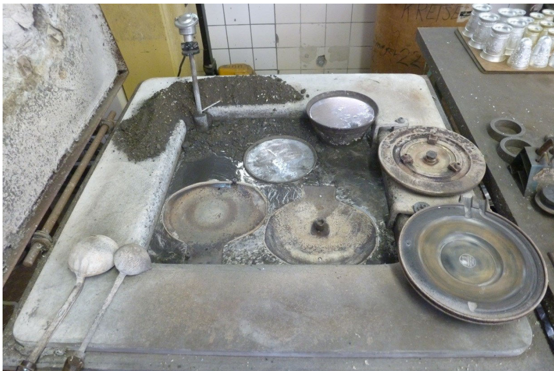
Abbildung 8-6 Schmelzofen mit eingelegten Gussformhälften für das Heißgussverfahren in der Zinnmanufaktur Kreiselmeyer. Die Form wird so auf die gleiche Temperatur (ca. 400 °C) gebracht, wie das flüssige Zinn. Auf der Zinnschmelze sind eine die durch oberflächliches Abkühlen entstehende Haut sowie Schlacke zu sehen.
