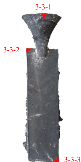
Abbildung 8-29 Exemplarische Darstellung der Probenahmestellen (rot markiert) für das Gussstück 3-3.
