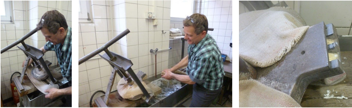
Abbildung 8-9 Langsames Abkühlen der Gussform von hinten nach vorne mit nassen Tüchern und mehrmaliges Nachgießen.
