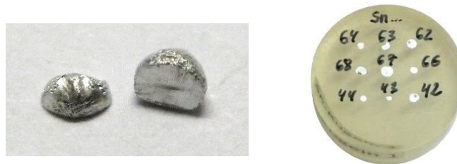
Abbildung 4-11 Durchgeschnittene und in Epoxidharz eingebettete Zinnkugeln (Ø 1-2 mm).
