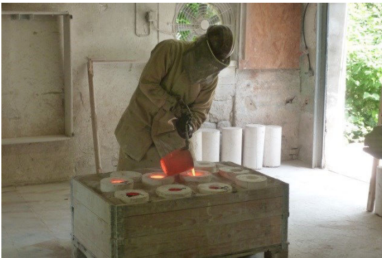
Abbildung 8-22 Abgießen der Gussformen.
