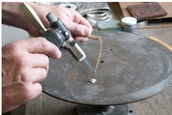
Abbildung 8-18 Links: Tropfprobe vom Gießkanal eines Bratwurstherzels, Rechts: Herstellung von Zinnloten aus der Zinnschmelze.
