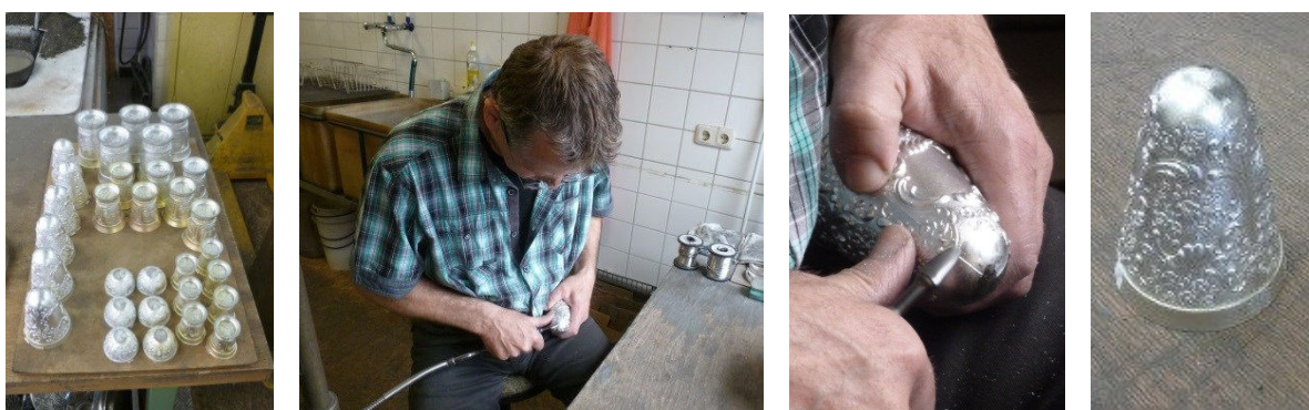
Abbildung 8-13 Abfräsen der Naht an einem Brautbecher.
