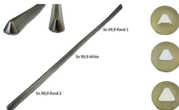
Abbildung 6-7 Dreieckstange Reinzinn Sn 99,9 % (200 g). Von drei Bereichen (Mitte, sowie 5 cm von beiden Enden entfernt) wurde jeweils ein 0,5 cm dickes Stück abgesägt und für Homogenitäts- und Sn-Isotopenmessungen in Epoxidharz eingebettet (Ø 2,5 cm).
