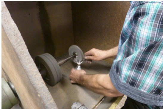
Abbildung 8-16 Für eine makellose Oberfläche und optimalen Glanz erfolgen mehrere Schleif- und Polierschritte.
