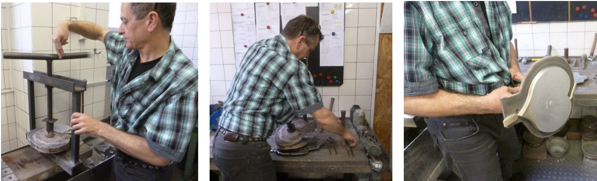
Abbildung 8-10 Ausspannen der abgekühlten Gussform und Herausschlagen des Gussgegenstandes (Bratwurstherzl).
