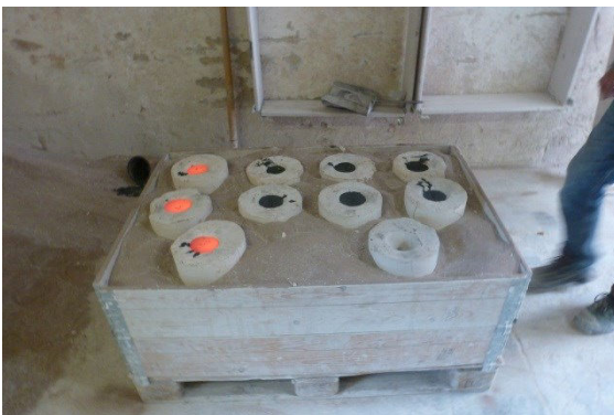
Abbildung 8-24 Fertig abgegossene Gussformen und Entnahme aus dem Zirkonsand.
