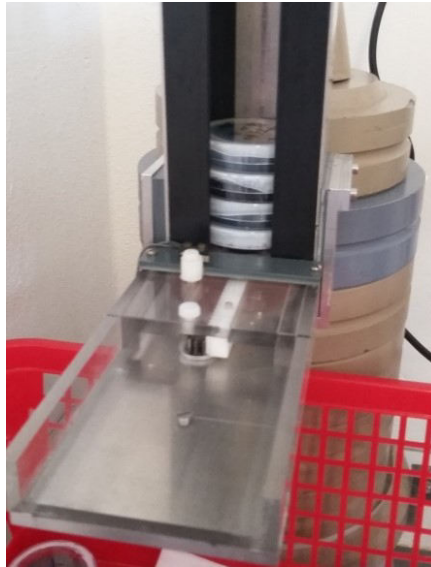
Abbildung 15: Petrischalen im automatischen Probengeber des NaI-Detektors eigenkonstruiert von Dipl. Biol. Rüdiger Sachse.
