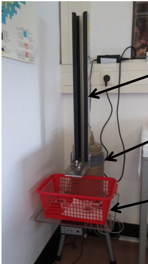
Abbildung 13: NaI-Detektor mit automatischem Probengeber für Petrischalen. Eigenkonstruktion von Dipl. Biol. Rüdiger Sachse.
