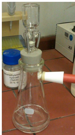
Abbildung 32: Fritte und Nutsche zum Abfiltrieren von Silberiodid.
