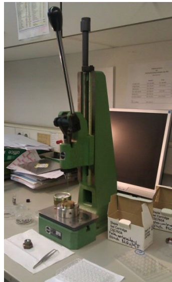
Abbildung 36: Vorrichtung für das Pressen des Silberiodids in die Probenhalter.
