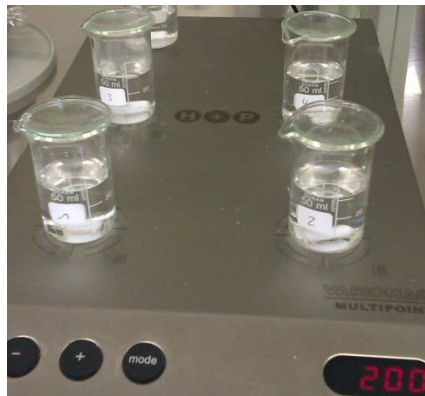
Abbildung 31: Mehrfachmagnetrührer mit Wasserproben nach Zugabe von Calciumhypochlorit.
