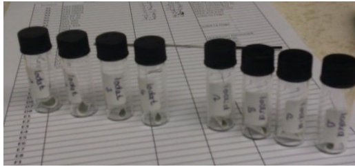
Abbildung 34: Getrocknetes Silberiodid auf Filterpapieren in Schraubdeckelgläsern.
