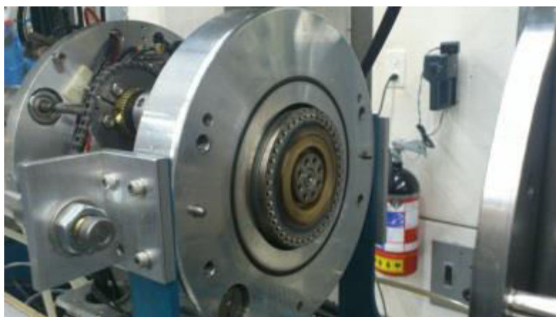
Abbildung 18: Probenrad der Ionenquelle der AMS [23].
