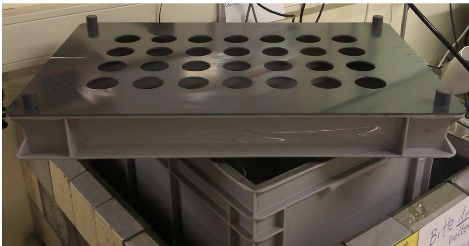
Abbildung 38: Deckel mit 28 Löchern für Aktivkohlefilter.
