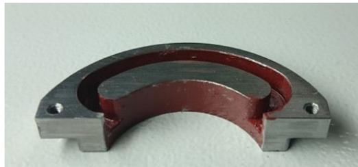
**Bild 3.10:** Foto eines Aktorkerns aus St37, bestrichen mit Isolationslack (rot)
