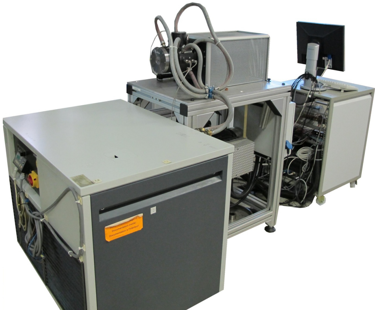
Abbildung 4-3: Kombiprüfstand mit Messrechner und Prozessthermostat am IMKT
