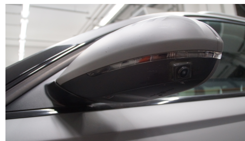
Abbildung A.9: Exemplarische Abbildung einer eingesetzten Fischaugenkamera des TopView-Systems
