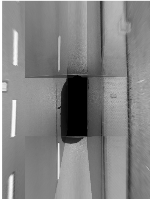
Abbildung 3.11: Vogelperspektive als Ergebnis der Projektion der 4 Fischaugenkameras auf die Bodenebene (erzeugt aus Abbildung 3.10)
