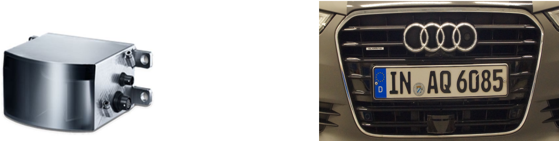
Abbildung A.6: Schematische Darstellung des Laserscanners (links) und die Integration im Versuchsträger (rechts)
