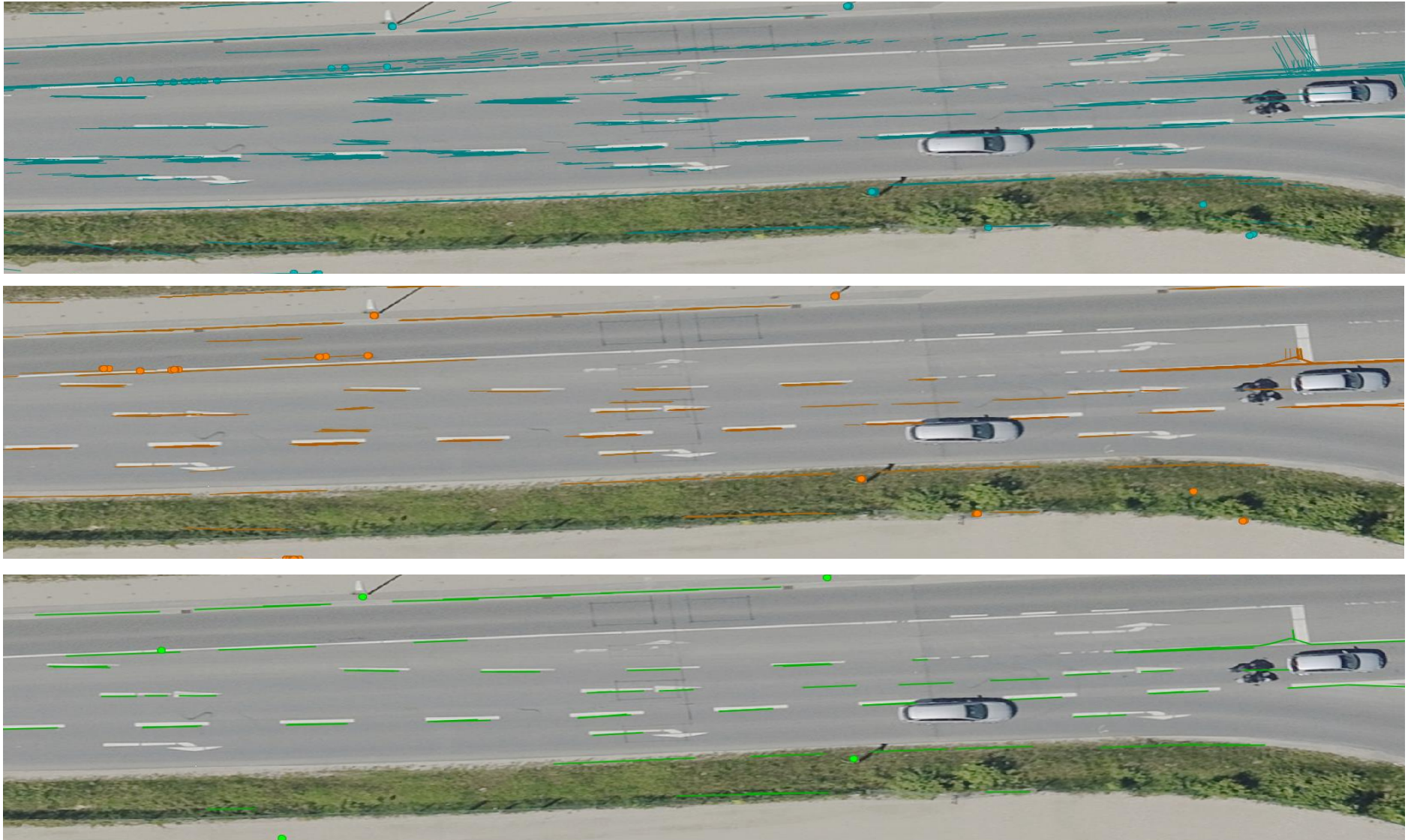
Abbildung C.4: Darstellung der Landmarken aus der Fusion im TFM in jeder Gütestufe (von oben nach unten: Level-1, Level-2 und Level-3)
