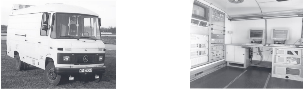
Abbildung 2.1: Versuchsfahrzeug VaMoR (links: von außen, rechts: innen) [61]
