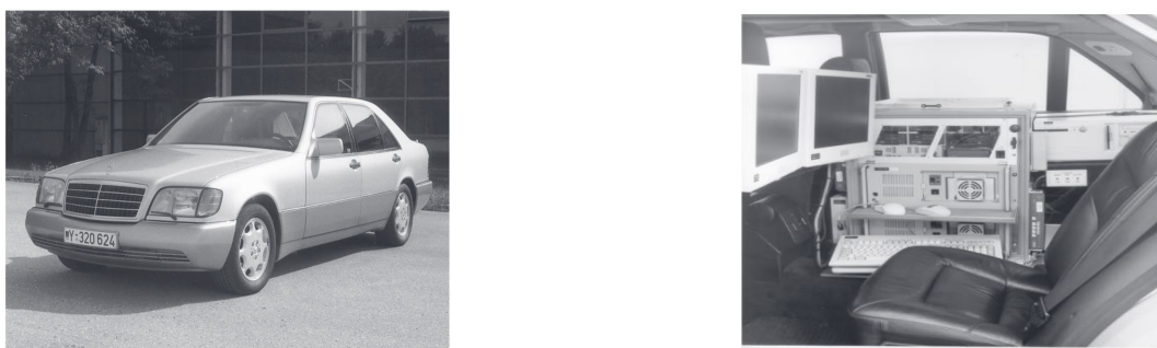
Abbildung 2.2: Versuchsfahrzeug VaMP (links: von außen, rechts: innen) [66, 67]
