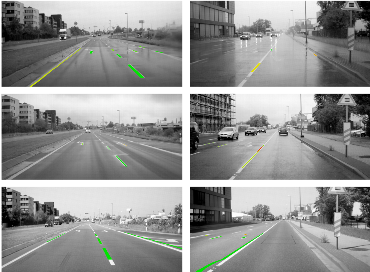
Abbildung 5.33: Umgebungswahrnehmung je Kategorie mit der Front-Monokamera (oben: Regen, mittig: Nässe, unten: Trockenheit; links: um die WGS84-Koordinaten (52.422850, 10.733267), rechts: um die WGS84-Koordinaten (52.424780, 10.727473))
