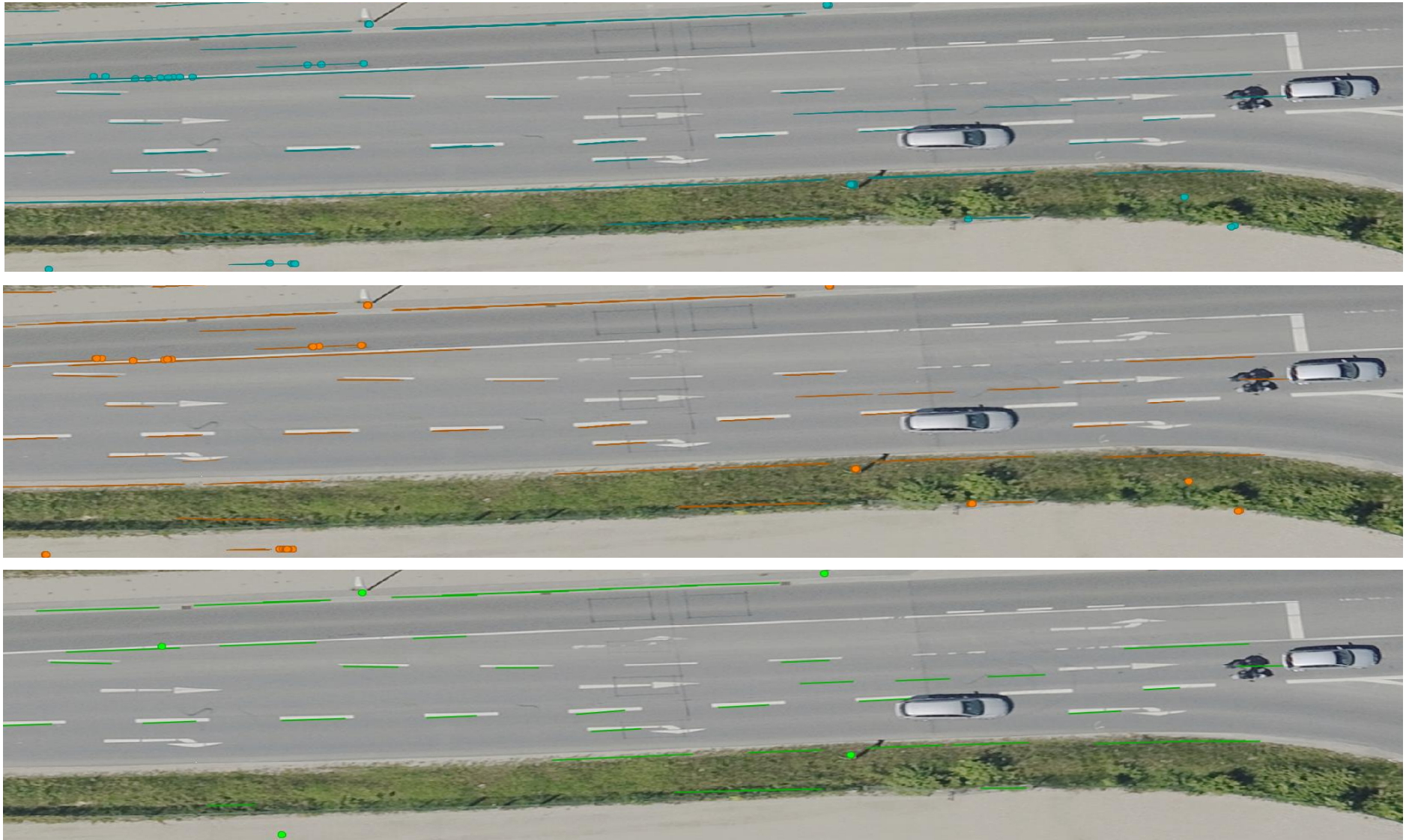
Abbildung C.2: Darstellung der Landmarken des Laserscanners in jeder Gütestufe (von oben nach unten: Level-1, Level-2 und Level-3)
