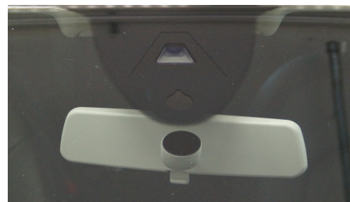
Abbildung A.8: Darstellung der Front-Monokamera (links) und deren Integration im Versuchsträger (rechts)
