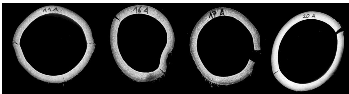
Abb. 29: Abweichung von der Rotationssymmetrie durch Trocknungsrisse und Verformung durch Querpressung während der Lagerung.
