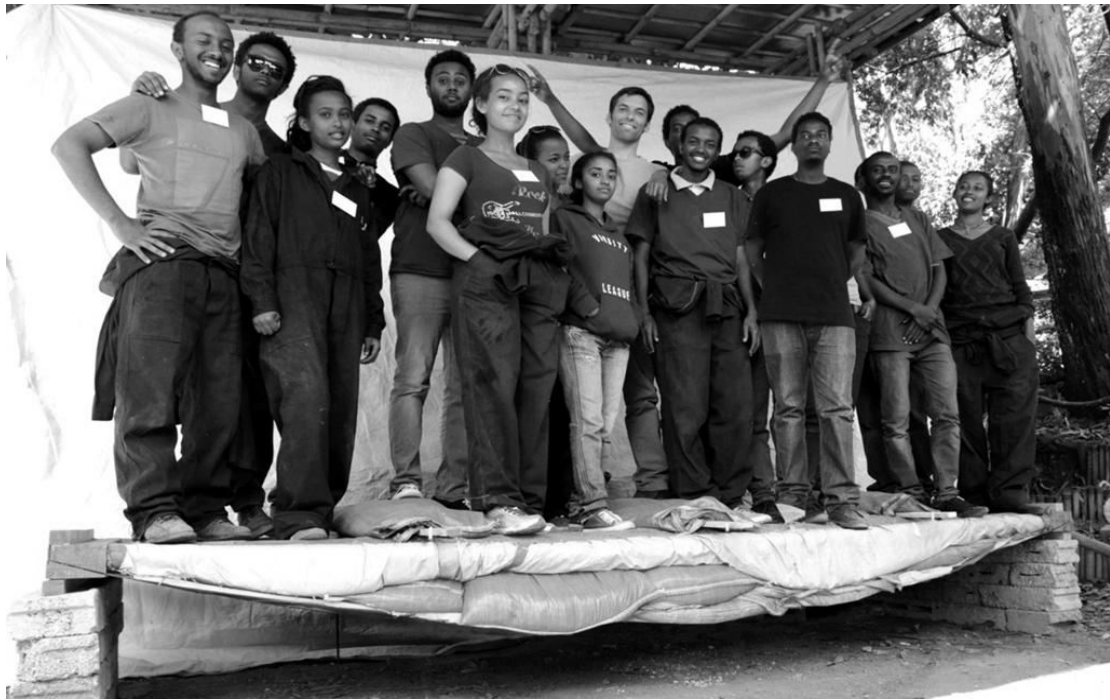
Abb. 131: Belastungstest am PK375-U mit einer Nutzlast von 2,84 \text{ kN/m}^2 . Die Verformung in Feldmitte betrug dabei 4 \text{ mm} , was einem Verhältnis zur Spannweite von 1/940 entspricht.
