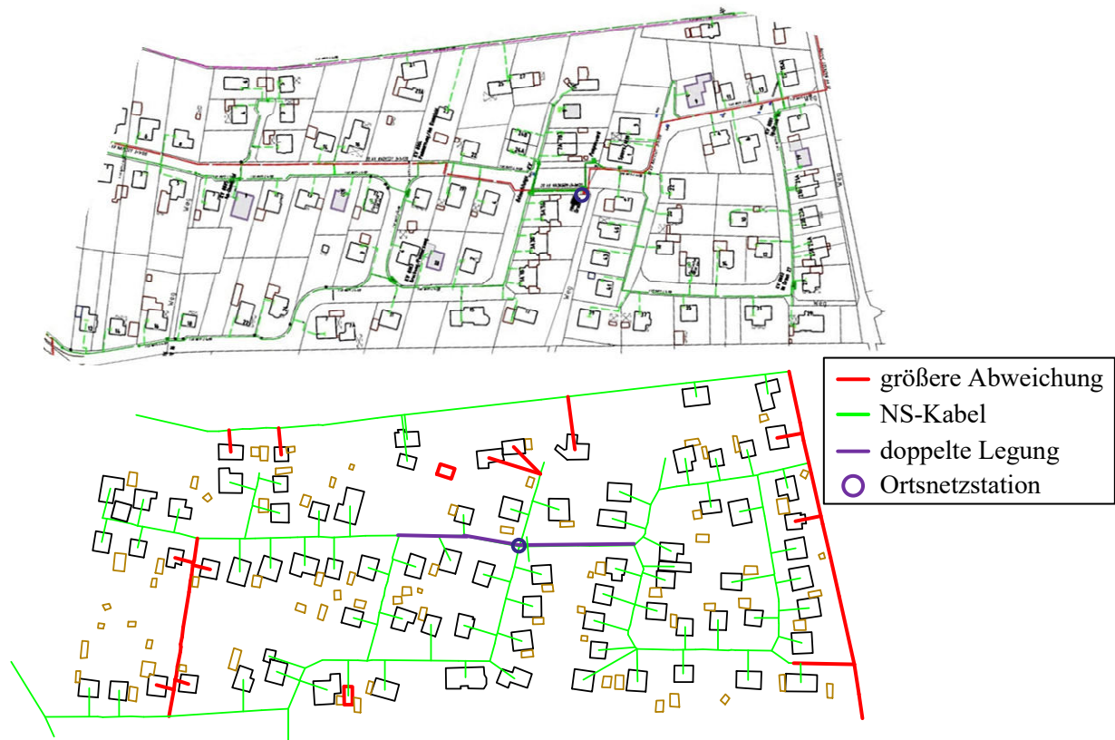
Bild 4.14 Vergleich zwischen realem Netzplan (oben) und der Netznachbildung (unten)
