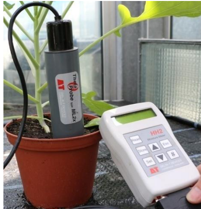
Abbildung 31: Messung der Substratfeuchtigkeit mit dem Bodenfeuchtigkeitssensor, dargestellt am Beispiel einer Rosenkohlpflanze.
