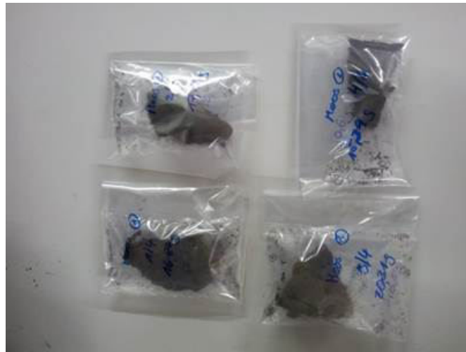
Abbildung 6.1: Probenaufteilung für die Gammaskpektrometrie-Messungen
