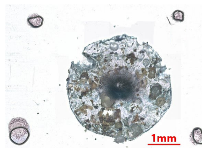
(f) Das Übereinanderlegen von Proben- und Detektoraufnahme zeigt die Position des Hot Particles an.
