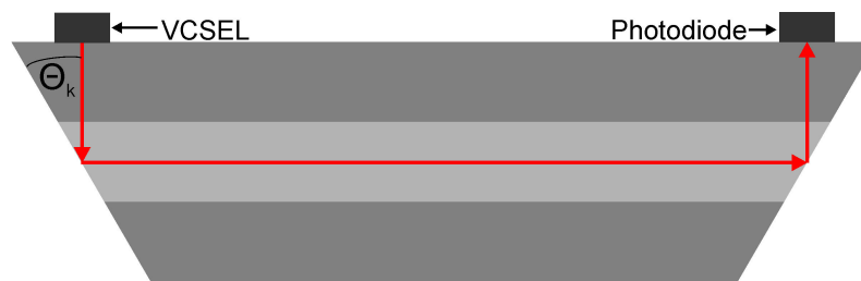
Abbildung 2.10: Beispielhafte Nutzung eines Spiegelkopplers zum Ein- und Auskoppeln von Licht mittels VCSEL und Fotodiode.
