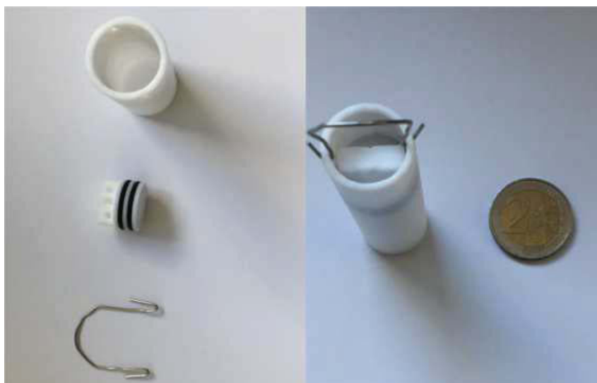
Abbildung 14. Teflonzylinder zur Durchführung von Reaktionen unter Hochdruckbedingungen.
