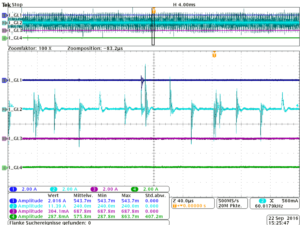
Abbildung 5-85: Rotor-Erd-Ströme aller Getriebelager bei Drehzahl +1200 min -1 , 37,3 Nm Belastung und 30°C Öltemperatur. Bei jeder Schalthandlung des Umrichters kommt es zu Rotor-Erd-Strömen, die hauptsächlich über das Lager GL2 abfließen.
