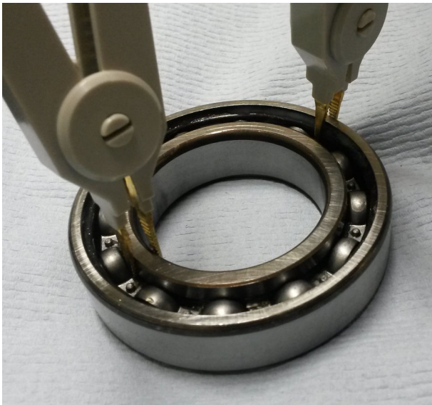
Abbildung 6-7: Messung der Lagerkapazität zwischen Innen- und Außenring am Hybridlager C6008
