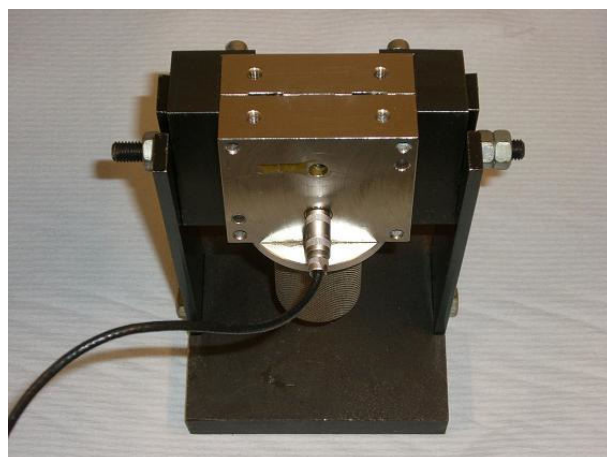
Abbildung 4-1: Messgerät zur Bestimmung der Dielektrizitätszahl bei Umgebungsdruck [Bal05]
