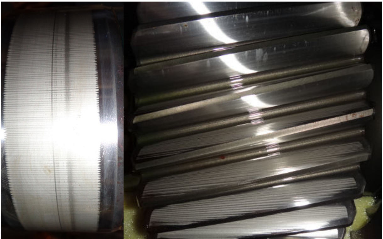
Abbildung 2-10: Stromdurchgangsschäden: Links: Riffelbildung am Wälzlager. Rechts: Grauflecken/Streifigkeit der Zahnflanken
