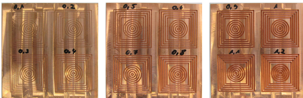
Abb. A.1: Die gefrästen Rillen im Kupfer. Sie sind 0,1 bis 0,4 mm tief. Abb. A.2: Die gefrästen Rillen im Kupfer. Sie sind 0,5 bis 0,8 mm tief. Abb. A.3: Die gefrästen Rillen im Kupfer. Sie sind 0,9 bis 1,2 mm tief.
