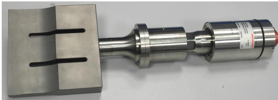
**Abb. 1.1:** 20 kHz Ultraschallschweißwerkzeug [2].
