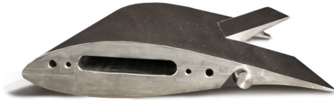
Abbildung 2.5: Profil mit Wölbklappe als Untersuchungsobjekt
