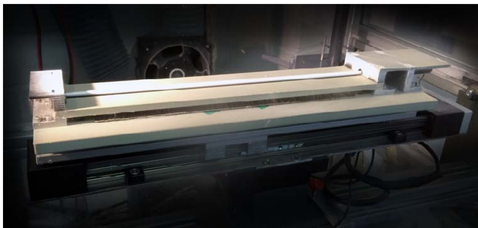
Abbildung 7.21: Kollektor zur Produktion von bis zu 40 cm langen elektrogewebenen Röhrchen. Der Kollektor ist auf einer Schiene montiert und kann über einen Motor translativ verschoben werden, so dass die Gleichmäßigkeit der Faserablage maximiert wird.
