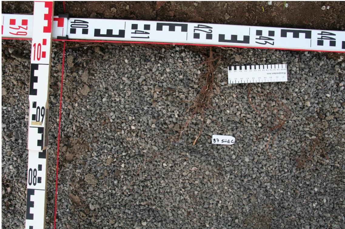
**Abb. 42:** Nach Auflockerung der Bettungsschicht wenige ersichtliche Wurzeln bei der Variante V6 (HKS 2/5) auf der Südseite des Baumes B7; Oberkannte Bild entspricht der Baumseite
