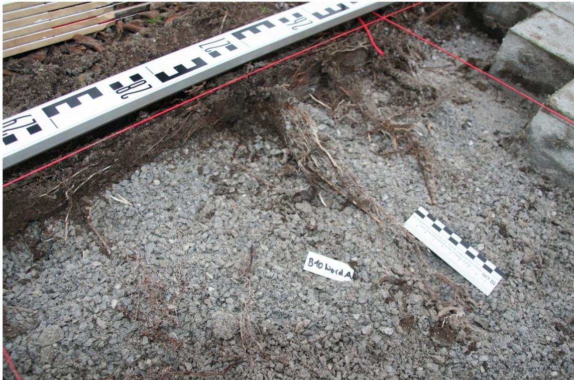
**Abb. 50:** Wurzelbild nach Entfernen der Pflastersteine der Variante V0 auf der Nordseite des Baumes B10; Oberkannte Bild entspricht der Baumseite. Wurzeln wachsen in die Pflasterfugen ein.
