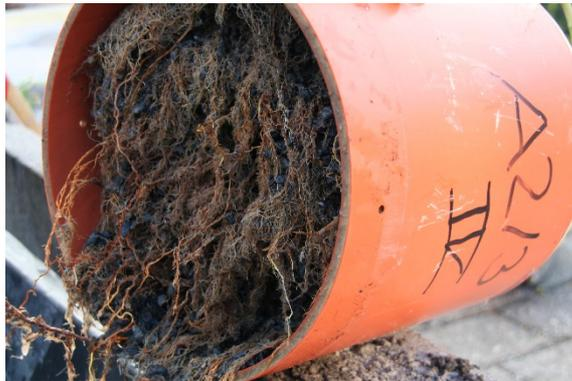
**Abb. 72:** Entfernung der KG-Rohr-Kappe und Beginn des Ausspülens des Bettungsstoffes bei der Variante A2 (Karbon Quarzit 0/8). Wurzeln im Bereich des Bettungskörpers ersichtlich.
