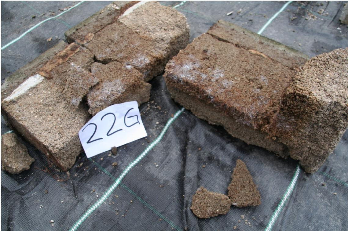
**Abb. 106:** Teile des Mörtelblocks der Variante TPM-D Portlandzement + Kalksteinmehl (22G)
