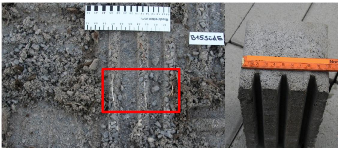
**Abb. 51:** Weiße, feine Wurzeln nach Entfernen des Steins mit der profilierten Steinunterseite (Variante V3) auf der Südseite des Baumes B15 (links). Unterseite des profilierten Betonpflastersteins (rechts).
