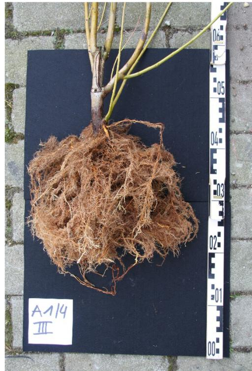
**Abb. 71:** Gewaschener Wurzelballen der Variante A1 (Karbon Quarzit 0/5); gesamter Bettungskörper durchwurzelt, viele Wurzeln über 1 cm Durchmesser durchwurzelt.
