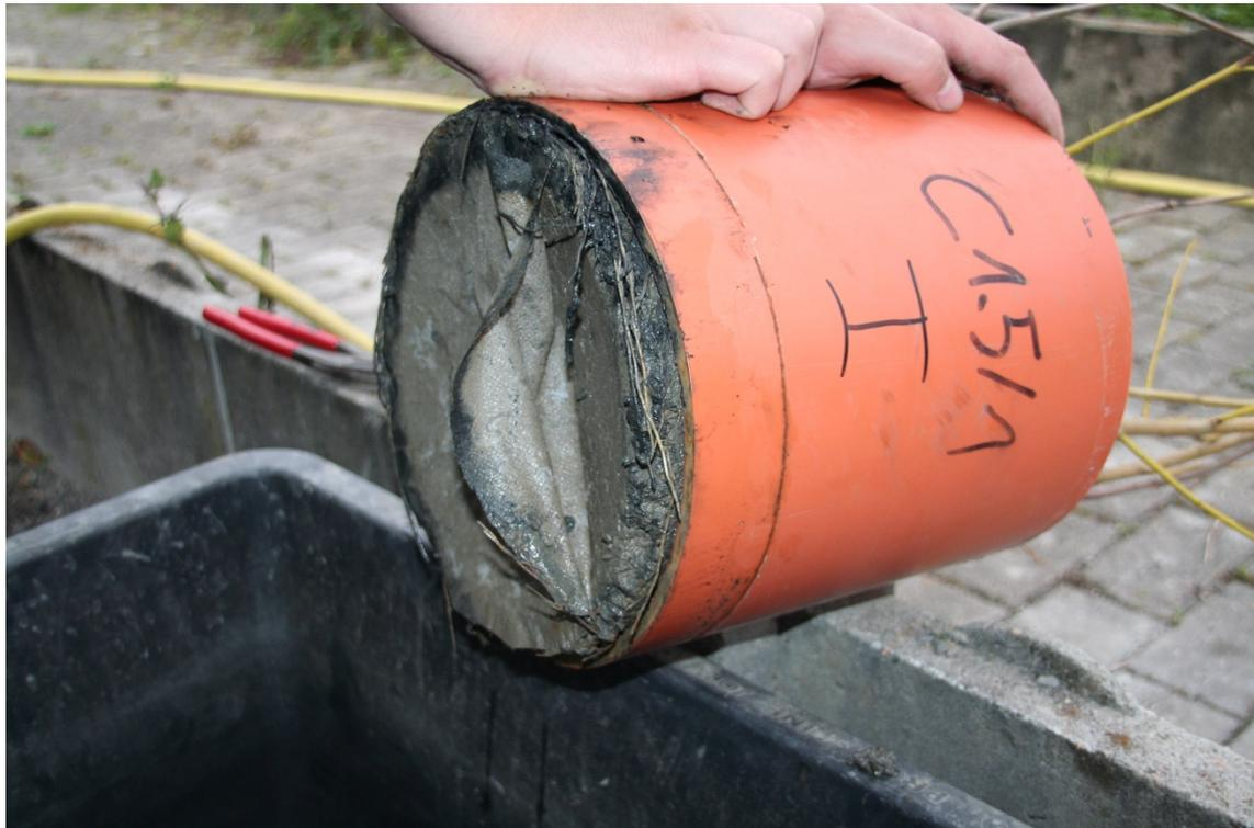
**Abb. 66:** Entfernung der KG-Rohr-Kappe bei der Variante C1.5 (Karbon Quarzit 0/11; 16,5 M.-% Schluff); kein Wurzelwachstum im Bettungsstoffkörper, Wurzelwachstum in der Grenzzone zum Rohr
