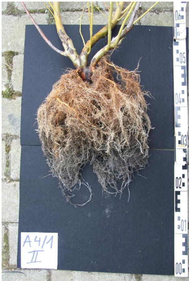
**Abb. 63:** Gewaschener Wurzelballen der Variante A4 (Karbon Quarzit 2/5); Durchwurzlung des gesamten Bettungskörpers
