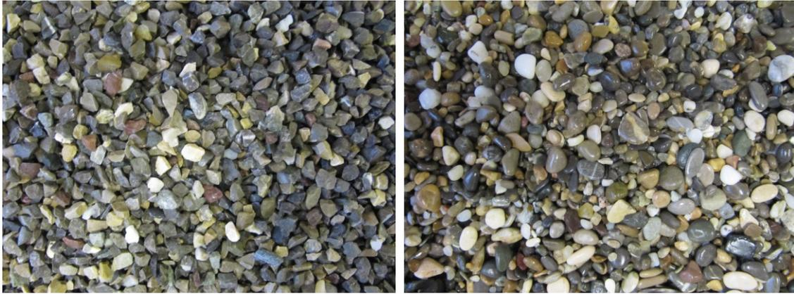
Abb. 24: Donau-Moos-Kies als gebrochenes (linkes Bild) und rundes (rechtes Bild) Material
