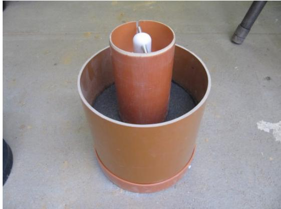
**Abb. 27:** Schichtenweiser Einbau der Stoffe mit Aussparung des Pflanzlochs (FOTO: KIBLER 2013)
