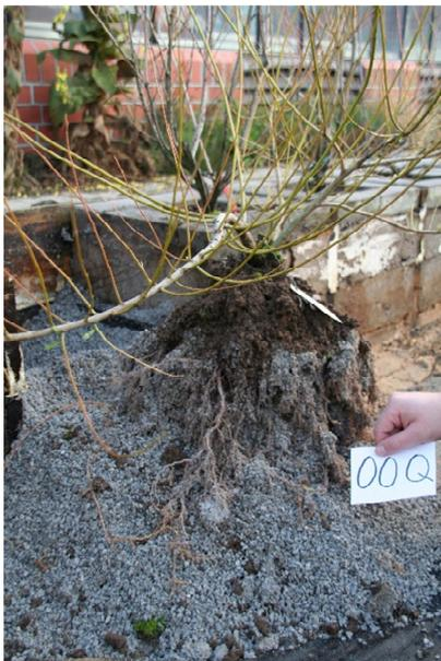
**Abb. 101:** Freigrabung des Wurzelballens der ungebundenen Variante (Versuchskörper 00Q mit 553,4 g Wurzelfrischmasse); Wurzeln erstrecken sich aus dem Substratkern heraus im gesamten ungebundenem Bettungsstoff.
