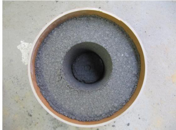
**Abb. 28:** Eingebauter Bettungsstoff mit definierter Proctordichte (FOTO: KIBLER 2013)
