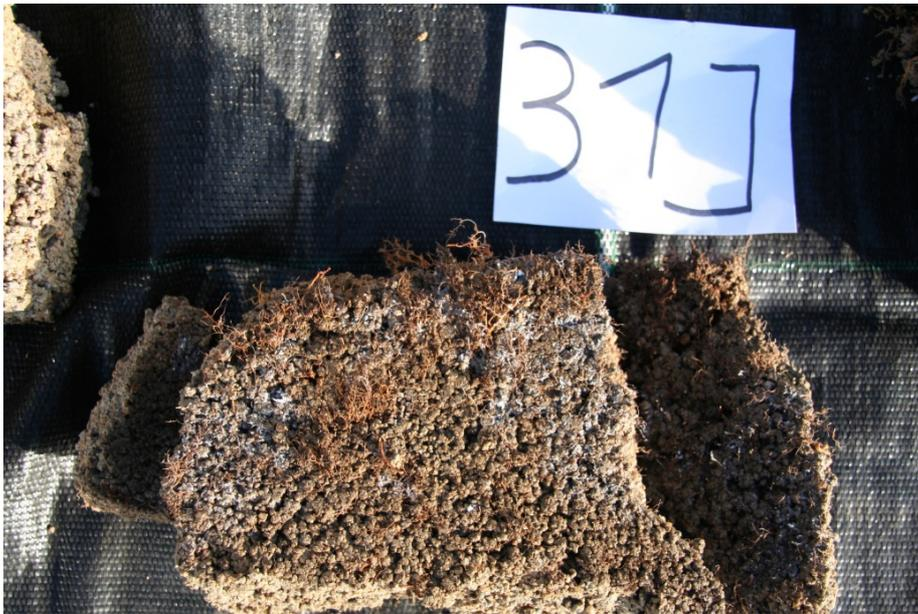
**Abb. 107:** Teile des Mörtelblocks der Variante TPM-D Portlandzement + Trass + Calciumsulfoaluminat (31J) Blockinnenseiten mit Wurzeldeckungsgrad-Rang 3 (hoch) zeigen nach oben.
