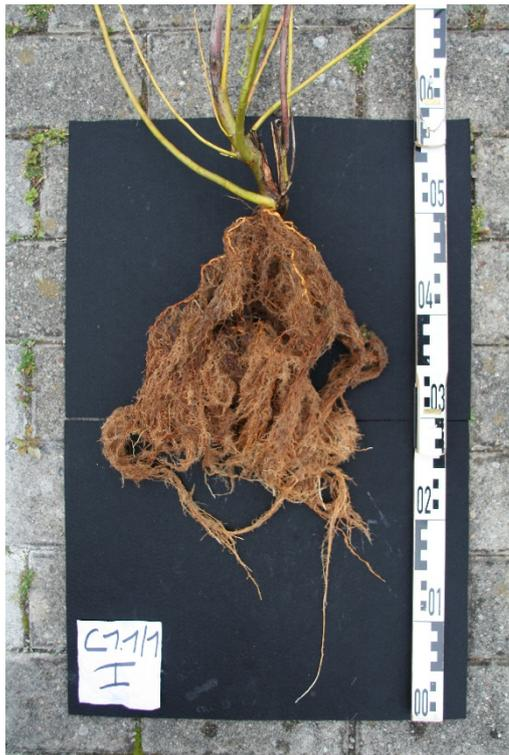
**Abb. 68:** Gewaschener Wurzelballen der Variante C1.1 (Karbon Quarzit 0/11; gewaschen mit 0,4 M.-% Schluffanteil)
