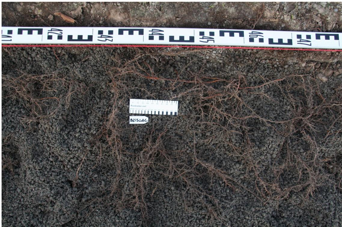
**Abb. 43:** Nach Auflockerung der Bettungsschicht vermehrt ersichtliche Wurzeln bei Variante V1 (Karbon Quarzit 0/5) auf der Südseite des Baumes B2; Oberkannte Bild entspricht der Baumseite
