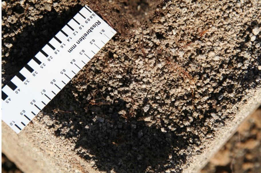
**Abb. 112:** Teil des Versuchsblocks der Variante TPM-D Portlandzement + Kalksteinmehl (23H) Draufsicht auf die Grenzschicht. Die feinen Wurzeln durchwachsen die komplette Grenzschichttiefe.
