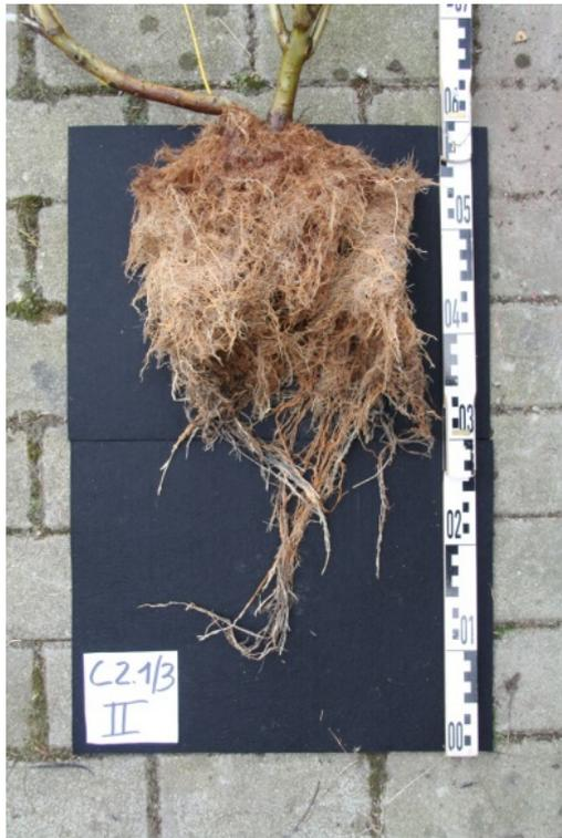
**Abb. 60:** Gewaschener Wurzelballen der Variante C2.1 (Karbon Quarzit 0/11; mit 1,1 M.-% Tonanteil); Wurzelwachstum in Substratkern, Grenzzone zum Rohr sowie kränzförmig im Rohdeckel
