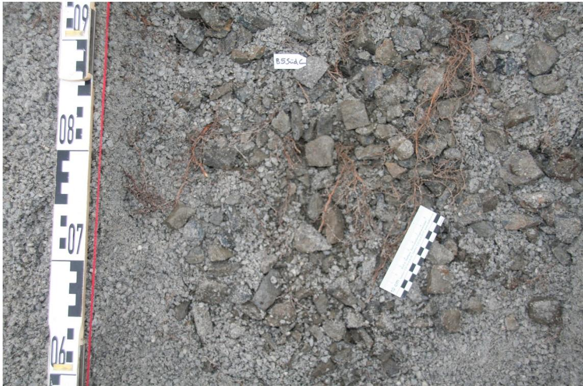
**Abb. 53:** Wurzeln aus der aufgerauten Tragschicht heraus nach oben in die Bettungsschicht wachsend bei Variante V4 (HKS (0/5) auf der Südseite des Baumes B5; linke Seite Bild entspricht der Baumseite
