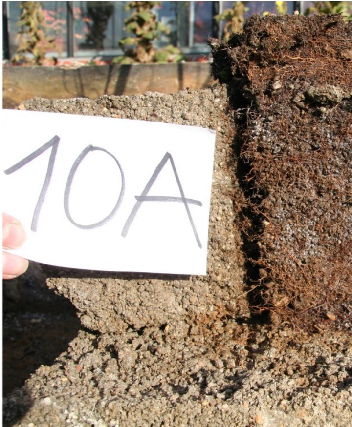
**Abb. 108:** Grenzbereich zwischen Wurzelballen und Mörtelblockinnenseite der Variante TPM-D Portlandzement + Trass (10A); Wurzelwachstum bis 1 cm in den Mörtelblock hinein.
