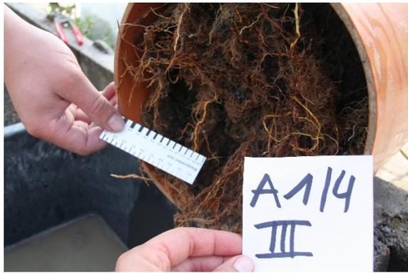
**Abb. 70:** Entfernung der KG-Rohr-Kappe und Beginn des Ausspülens des Bettungsstoffes bei der Variante A1 (Karbon Quarzit 0/5). Wurzeln im Bereich des Bettungskörpers ersichtlich.
