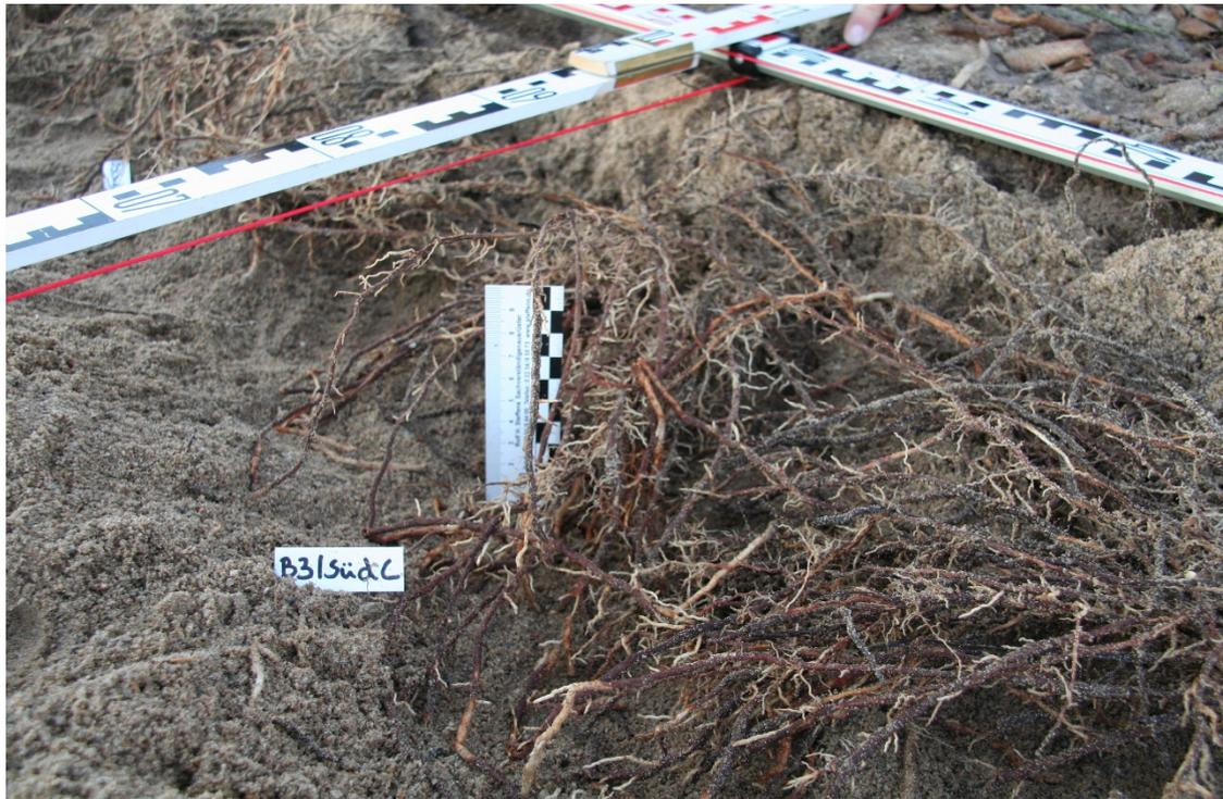
Abb. 44: Freigelegte fleischige Wurzeln im Bettungstoff der Variante V2 (hydrophober Sand) auf der Südseite des Baumes B3; Oberkante Bild entspricht der Baumseite
