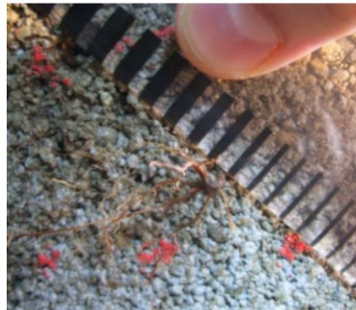
**Abb. 37:** Mit ROT markierte Rasterpunkte auf einer Innenseite eines Mörtelblocks und penetrierte Wurzel ca. 1,5 mm dick (vgl. KÜHN 2012, S.33)
