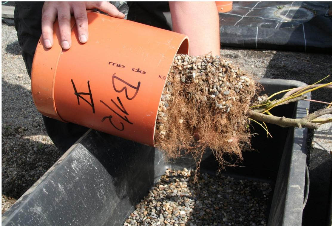
**Abb. 62:** Entfernung des KG-Rohres bei der Variante B1 (Donau-Moos-Kies mit runder Oberfläche); sehr feine Durchwurzlung des gesamten Bettungsstoffkörpers
