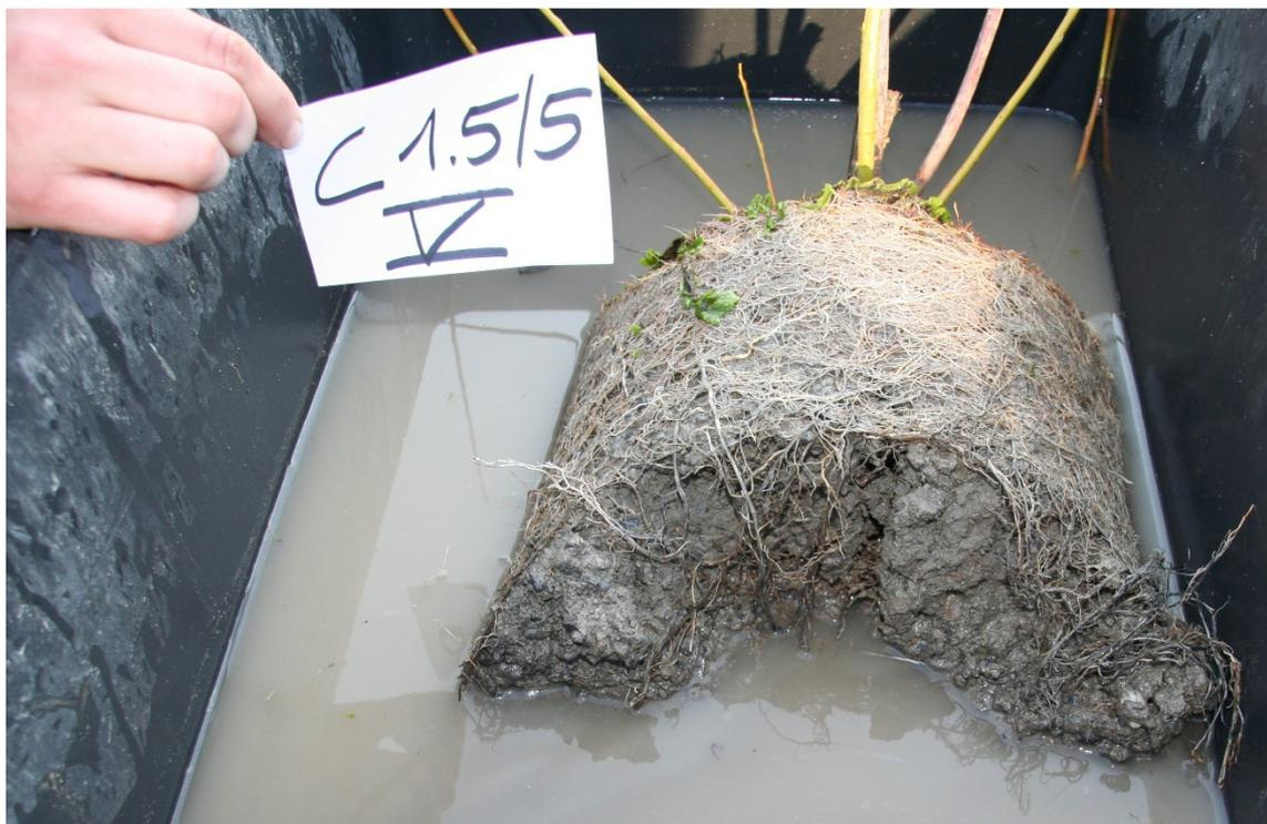
**Abb. 67:** Waschung des Versuchskörpers der Variante C1.5 (Karbon Quarzit 0/11; 16,5 M.-% Schluff); Bettungskörper wird von den Wurzeln netzartig umgeben. Kein Wurzelwachstum innerhalb des Bettungskörpers.
