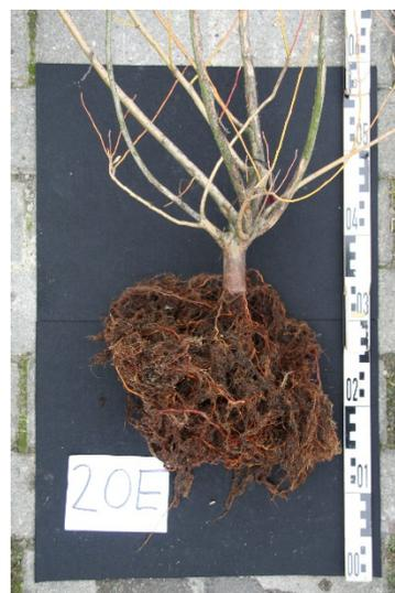
**Abb. 105:** Gewaschener Wurzelballen (aus Substratkern) der gebundene Variante TPM-D Portlandzement + Kalksteinmehl (Versuchskörper 20E mit 377,8 g Wurzelfrischmasse)
