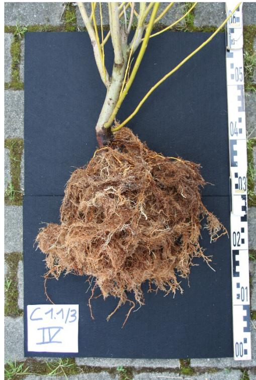
**Abb. 69:** Gewaschener Wurzelballen der Variante C1.1 (Karbon Quarzit 0/11; gewaschen mit 0,4 M.-% Schluffanteil)
