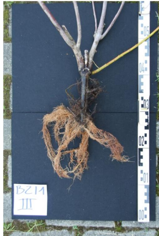
**Abb. 61:** Gewaschener Wurzelballen der Variante B2 (Donau-Moos-Kies mit gebrochener Oberfläche); Wurzelwachstum vermehrt im Substratkern und sehr feine Durchwurzelung des gesamten Bettungsstoffkörpers
