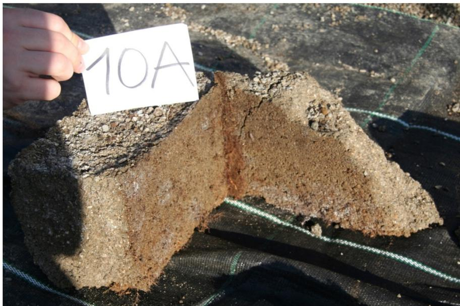
**Abb. 113:** Blockinnenseite der Variante TPM-D Portlandzement + Trass (10A); verstärktes Wurzelwachstum in den Ecken des Mörtelblocks
