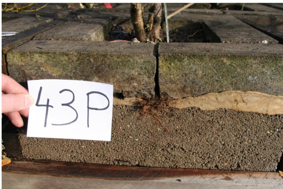
**Abb. 111:** Blockaußenseite der Variante TPM-D Portlandzement + Trass + Kaliwasserglas (43P); Wurzelwachstum zwischen Pflasterstein und Haftschlämme
