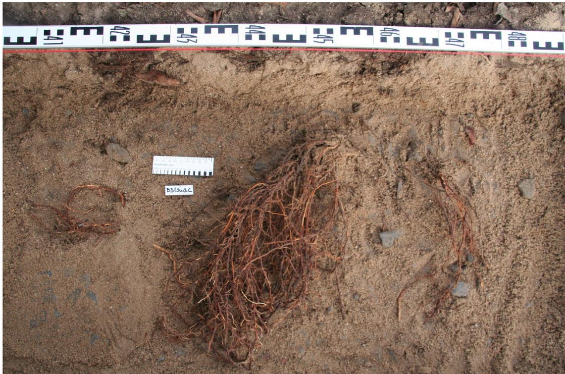
**Abb. 52:** Wurzeln aus der Tragschicht heraus nach oben in die Bettungsschicht wachsend bei Variante V2 (hydrophober Sand) auf der Südseite des Baumes B3; Oberkannte Bild entspricht der Baumseite
