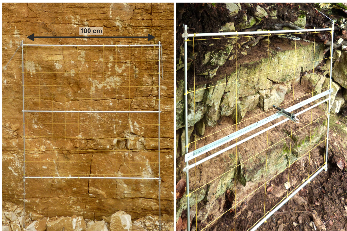
Abb. 12: Messraster zur Erfassung des Hohlraumvolumens von Gesteinsverwitterungsschichten. Das 100 mal 100 cm große Messraster ist aus Aluminiumrohren gefertigt, Messlinien sind durch eingespannte Schnüre markiert. Auf einer Metallschiene ist ein beweglicher Laser zur millimetergenauen Erfassung der Hohlräume im Gesteinskörper entlang der Messlinien montiert.
