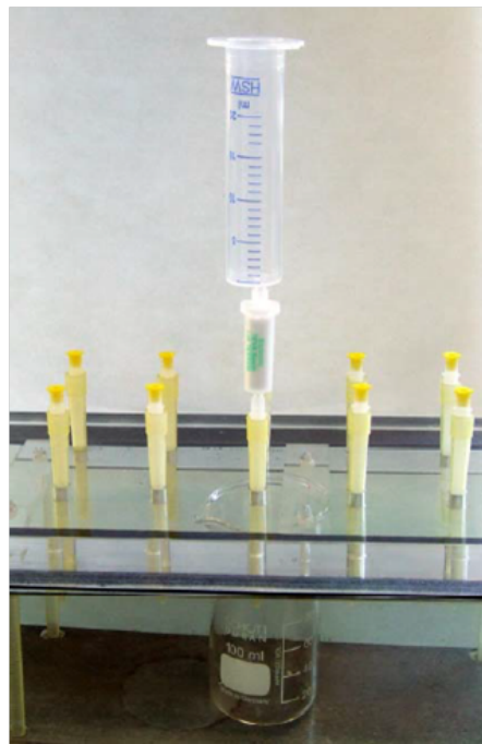
Abbildung 4.1.: Aufbau für die chemische Trennung mit Vakuumbox, TEVA-Säule, Spritzenkörper als Vorratsgefäß und Becherglas für das Eluat [Bis09]
